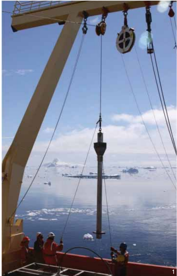
1 카스텐 코어러(Karsten Corer). 2 슬랩 퇴적물에 나타난 엽층 구조.
