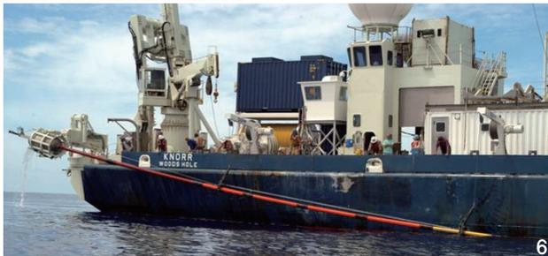
1 남극 지질 시추 프로젝트(ANDRILL) 개념도. 로스 빙봉을 뚫은 다음 수심 약 850미터 아래 해저층 두께 약 1,284미터를 시추하는 기술이다. 2 점보 피스톤(Jumbo Piston) 코어러. 3·4 중력(gravity)을 이용한 해저 퇴적물 시추 방법과 실제 운용 모습. 5 중력 코어러(gravity corer). 6 롱 코어 시스템(Long Core System).
