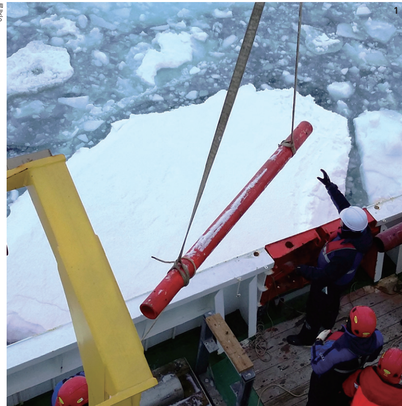
1 해저 퇴적물을 시추하기 위해 아라온호에 장착된 코어링 시스템을 설치하는 장면. 2 북극 척치해 심해 분지에서 획득한 14m 길이의 빙해양 퇴적물 코어의 일부. 빙하 역사와 고(古)해양 기후환경 변화 기록이 잘 보존돼 있다.
