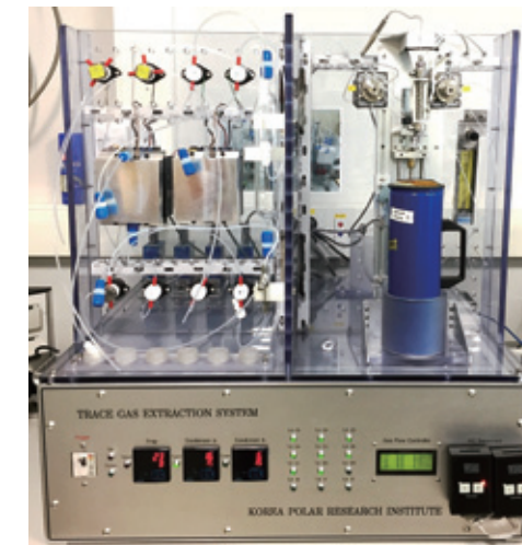
그림 1. 용존 N 2 O 분석을 위한 미량 기체 추출 장치
