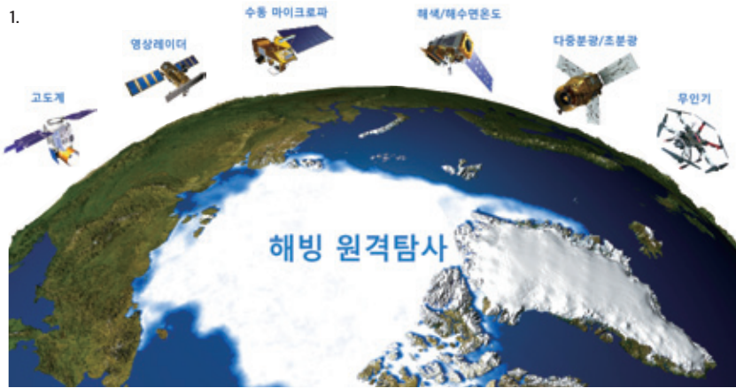
그림 1. 다양한 원격탐사 센서(영상레이더, 다중분광·초분광센서, 해색·해수면온도 센서, 수동 마이크로파 센서, 고도계, 무인기)를 통한 북극 해빙 관측 시스템
