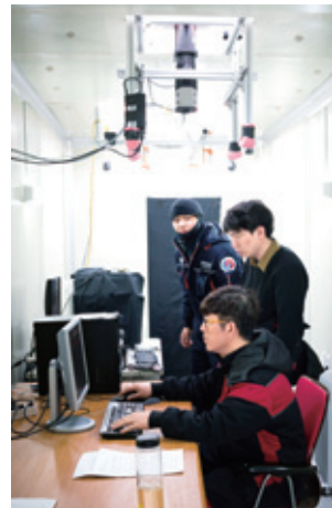
그림 1. 남극세종과학기지에 새로 구축된 우주환경 광학관측동 내부 모습. 열권 바람/온도 관측용 페브리-페로 간섭계와 대기광 관측용 전천카메라가 설치되어 있다.
