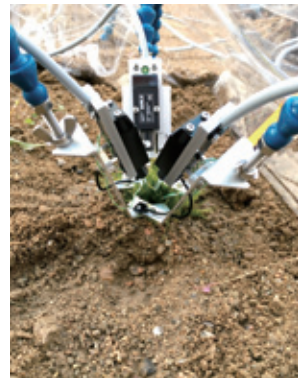
그림 1. 남극곰새풀에 광합성 형광측정기 3대를 동시 연결하여 광합성량을 모니터링하는 모습
