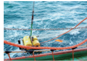
그림 1. 2016~2017년 하계 남극 현장조사 기간 중에 로스해에서 설치되고 있는 해저면지진계 모습
