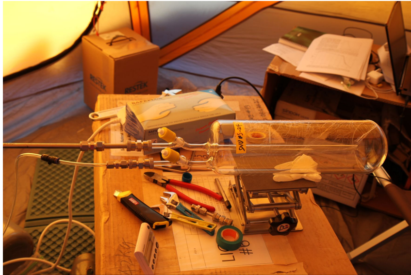
그림 4. 펌프장치에 연결된 firm air 포집용기
