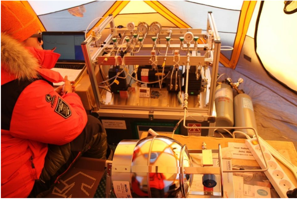
Figure 14. Firm air 샘플링 - Silco can 이용
