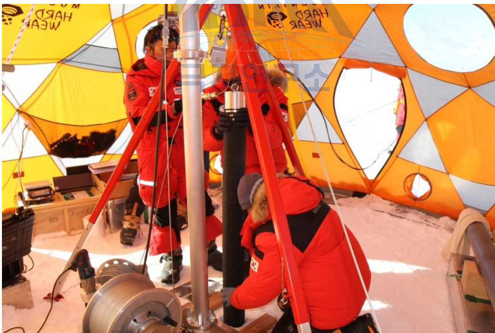
Figure 15. 시추공 내부에 bladder를 내리는 모습
