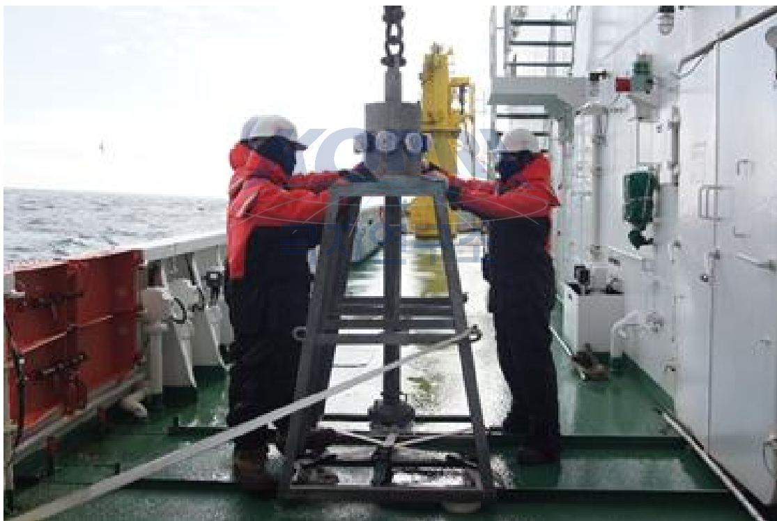
그림 12. 남극 중앙해령 탐사 시 사용한 락코어 사진
