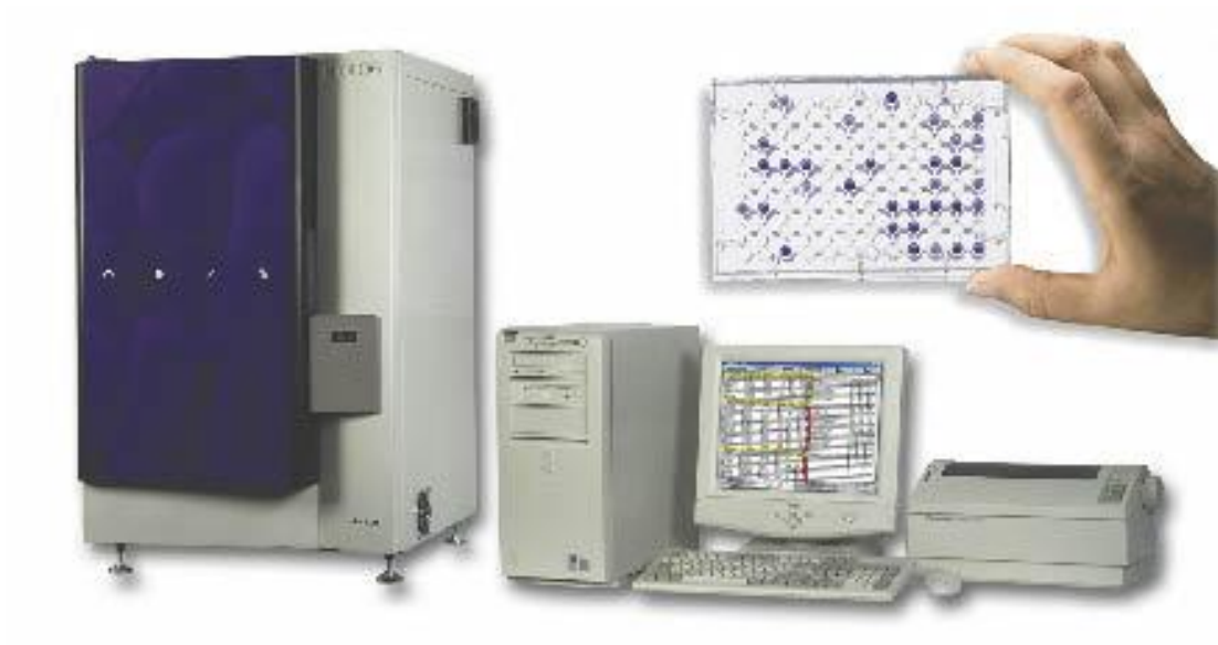
그림 5. 96 well plate와 자동화된 장비를 사용한 Biolog 분석법
