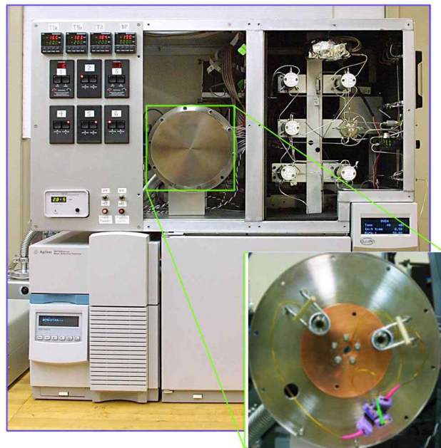
그림 20. 극저온 시료 흡착 기술을 활용한 대기 중 극미량 CFCs 분석기기
