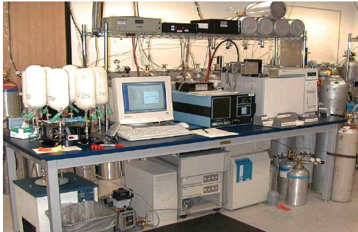
그림 19. NOAA 하와이 마우나 로아 관측소의 대기 중 N 2 O 분석 장치
