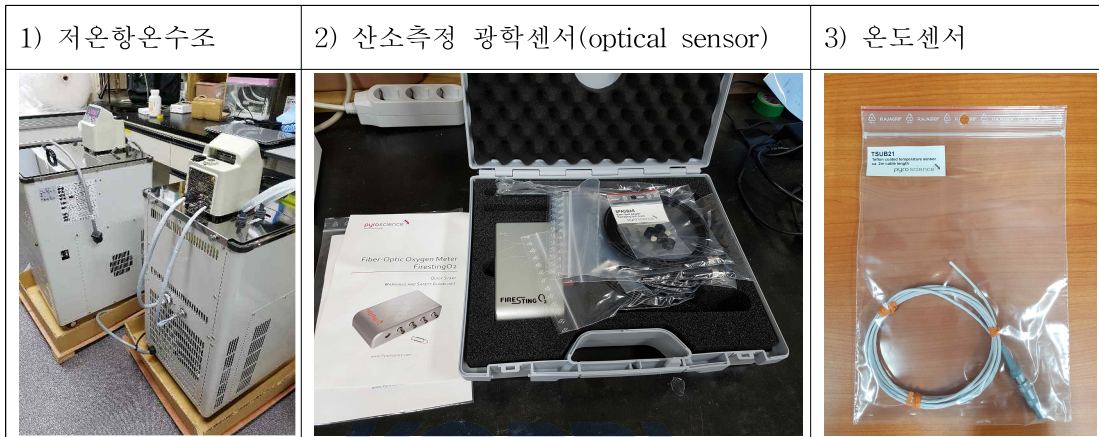
그림 4 Optical sensor를 이용한 미생물 호흡률 측정 장비
