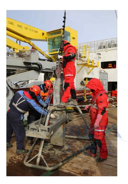
그림 4. Retrieving box corer.
