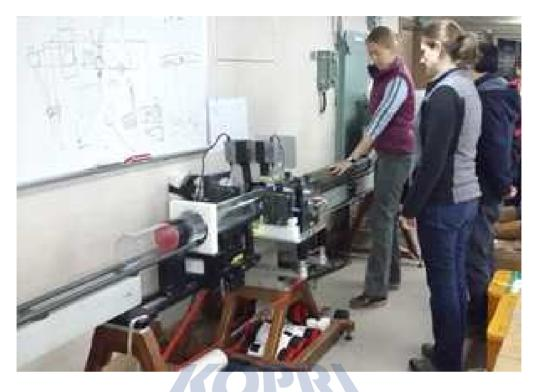
그림 5. 아라온 dry lab에 설치한 MSCL로 퇴적물의 물리적 특성을 분석하는 장면.
