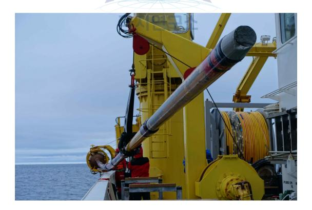
그림 4. 최초로 극지역에서 롱코어러를 이용해 얻어진 RS15-LC42 퇴적물 코어
