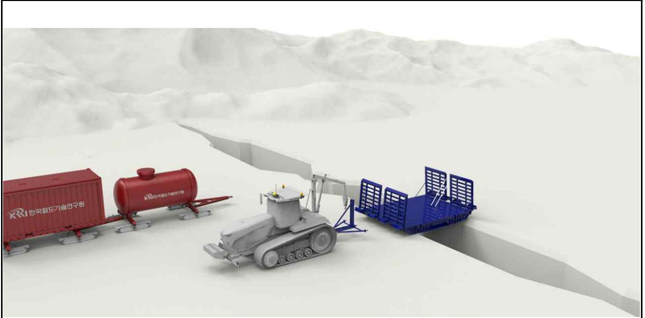
모듈러 교량 견인 장치 제거 - 트랙터 크레인을 견인장치 고리에 연결하고 견인장치와 교량 분리
