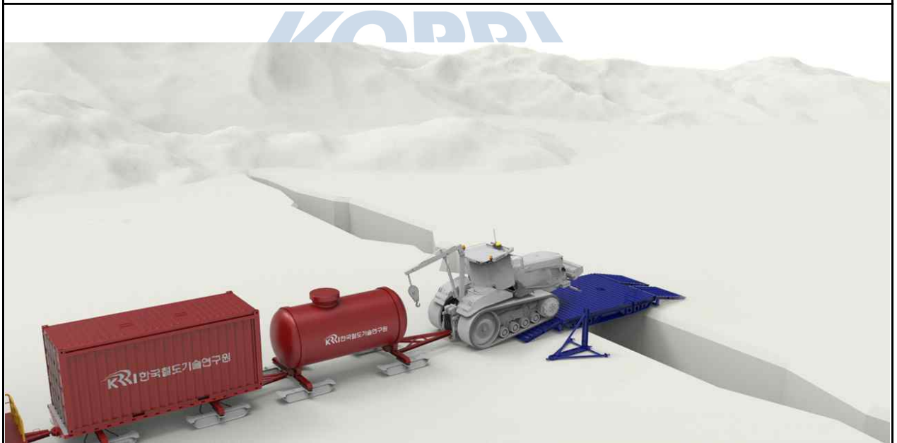
램프 고정 케이블 및 side stopper 제거 후 램프 내림
