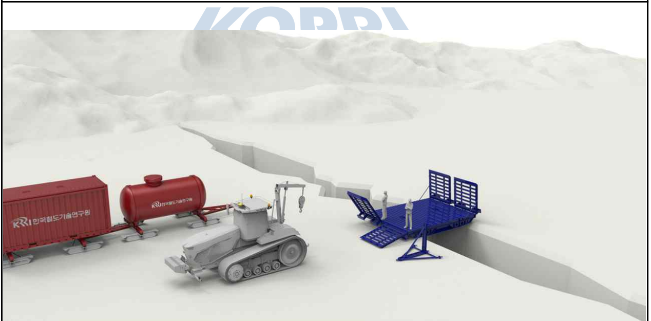
모듈러 교량 견인 장치 제거 - 트랙터 크레인을 견인장치 고리에 연결하고 견인장치와 교량 분리
