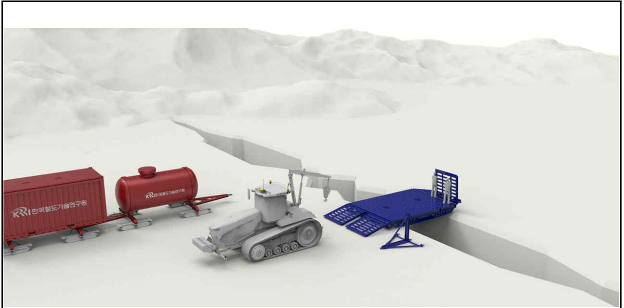
램프 고정 케이블 및 side stopper 제거 후 램프 내림
