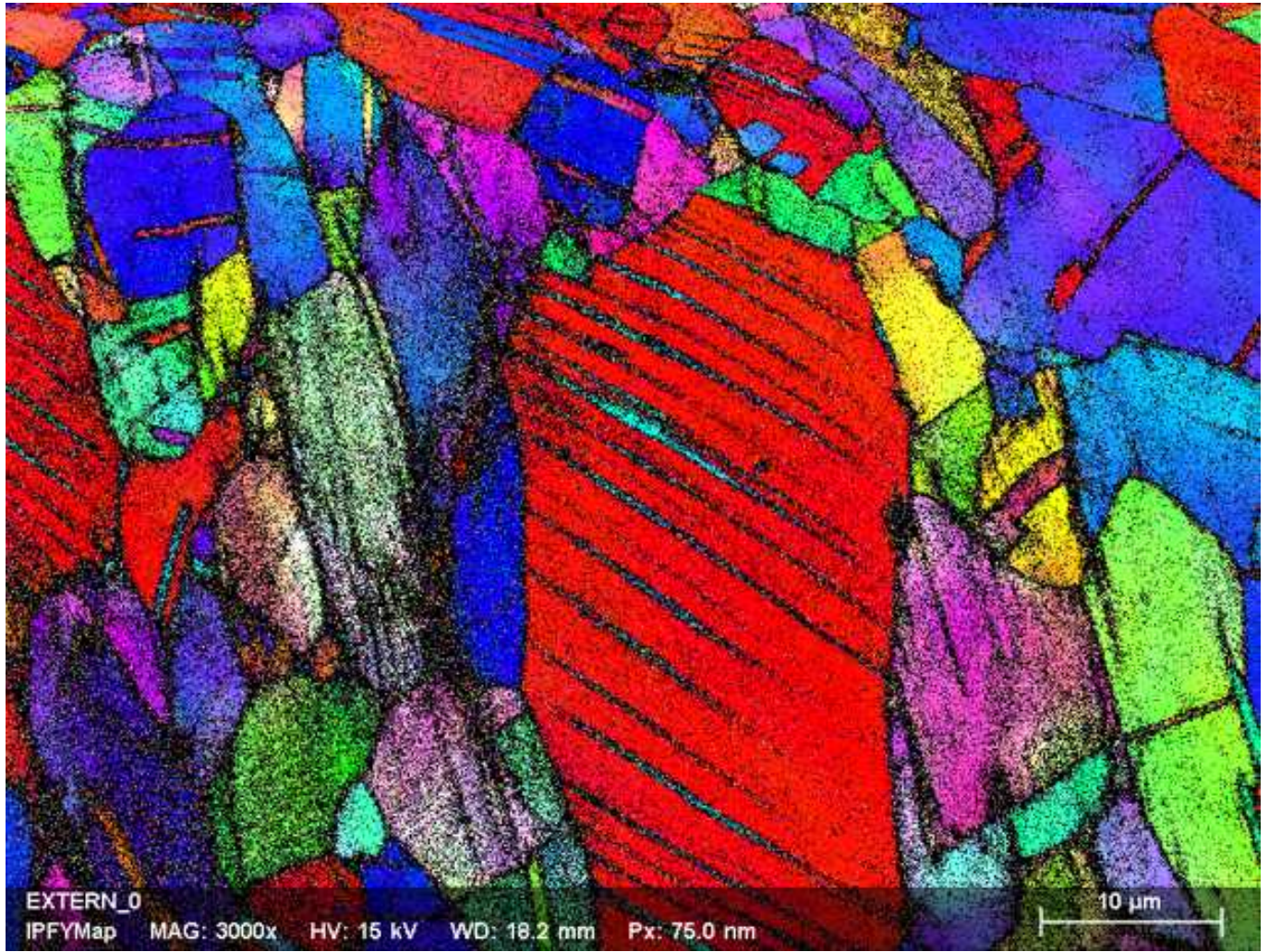
그림 26. TWIP 거동 합금의 CVNT 이후 EBSD 분석 결과
