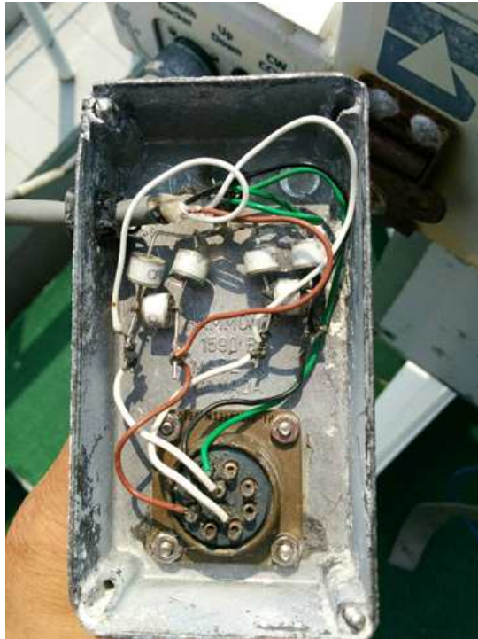
그림 2-11 세종기지 브루어의 서지 프 로텍터 내부의 모습
