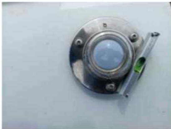
그림 2-8 세종기지 브루어의 수평 상태
