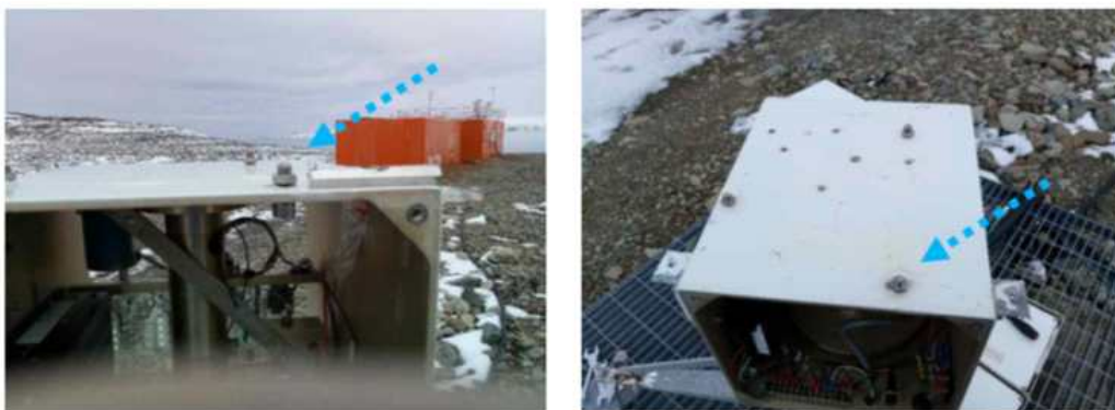
그림 2-7 트래커의 수평 나사의 상태
