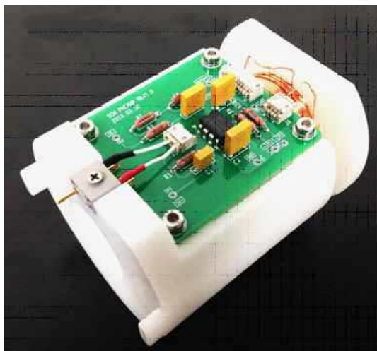
그림 39: 프리앰프보드 (우측)와 E-보드 링과의 장착모습 (좌측)
