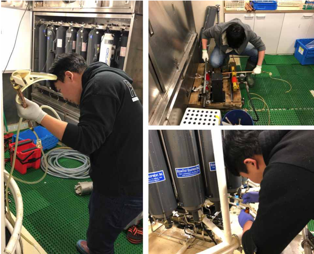
그림 2. 불활성기체 구리관 시료 채수모습(좌)과 구리관 절단(우상단), 불활성기체 선상분석용 유리병 시료 채수 모습(우하단).
