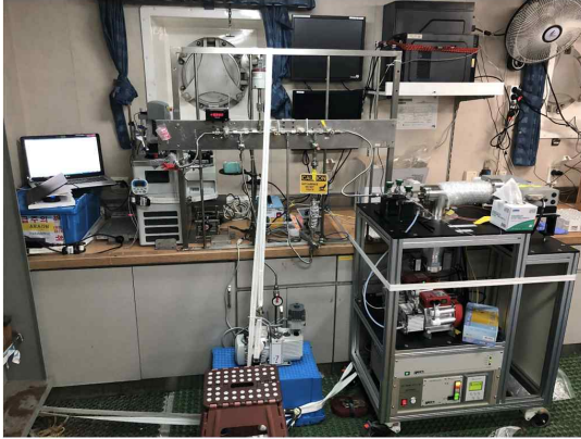
그림 6. 불활성기체 선상분석법에 사용한 분석시스템(좌)과 모식도(우).
