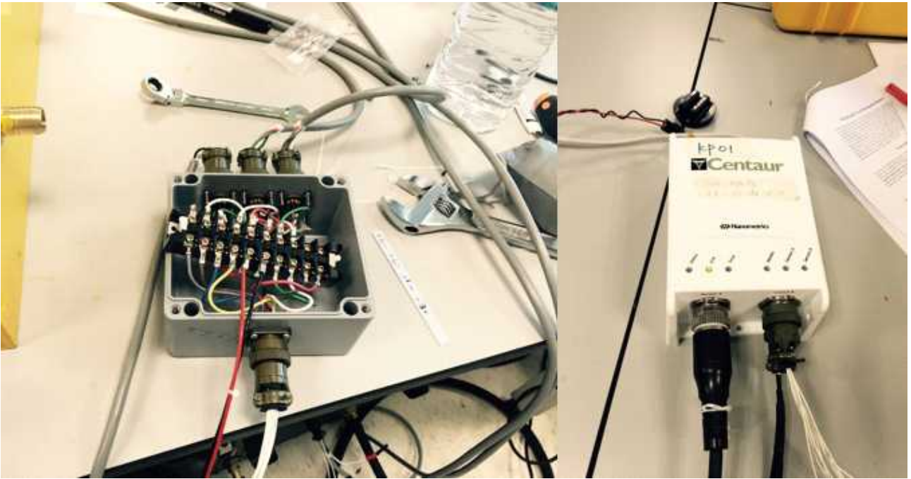
그림 41. 3개의 infrasound sensor를 병렬로 연결하여 지진기록계의 4-6ch의 하나의 port로 만들기 위한 병렬 병합 상자 개발. 기록계를 통합하여 비용 절감 및 장비 간소화
