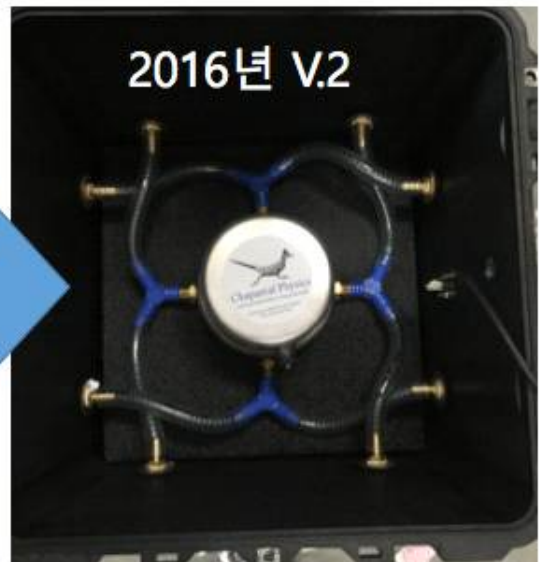
그림 24. 2015-16 남극 하계조사 기간중에 설치된 초기 인프라 사운드 보호 상자(v.1)와 입력 신호 강도를 높이기 위한 벨브 직접입력 방식으로 개량된 펠리칸 박스 형태의 보호 상자(v2)
