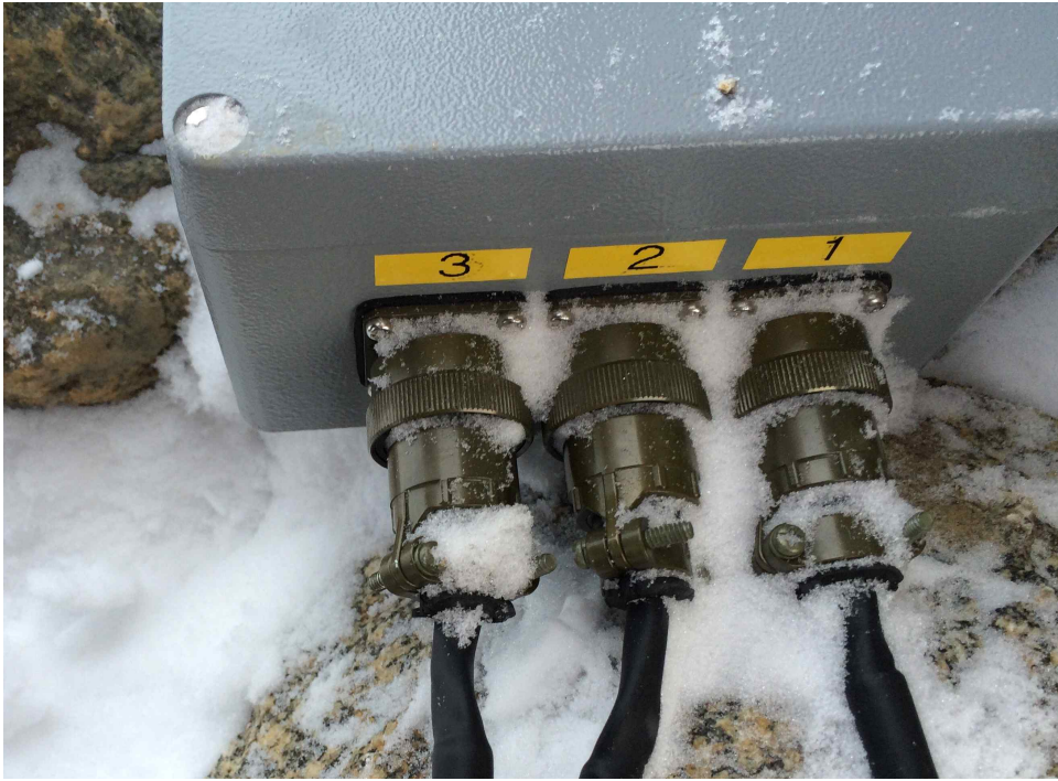
그림 25. 지진기록계(Centaur 6ch)에 연결하기 위한 인프라 사운드 센서 병렬 상자
