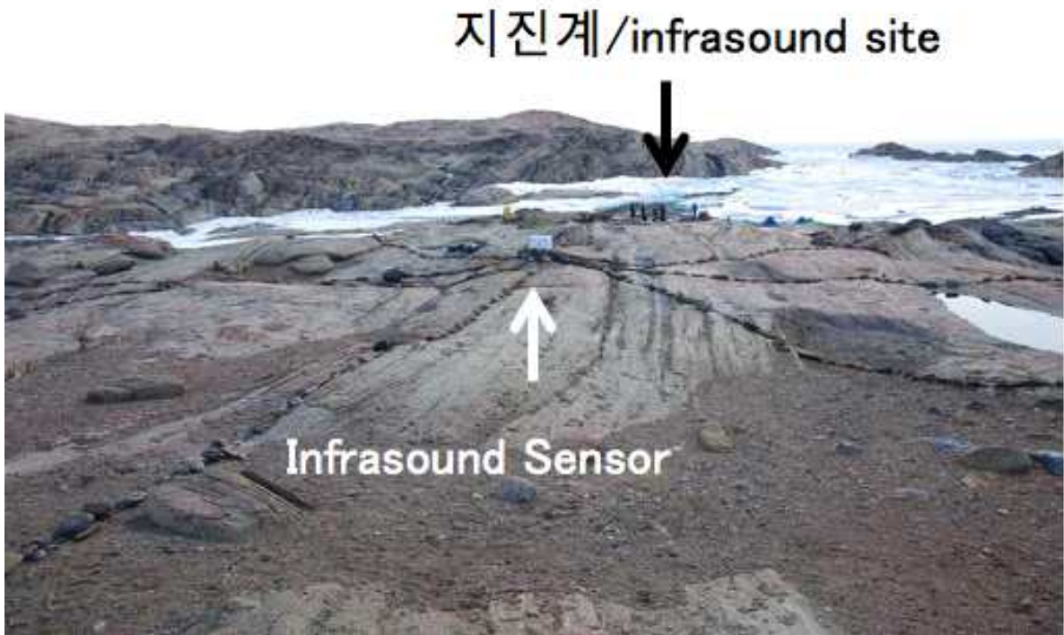
그림 46. 그림 34의 지진계/infrasound site와 연결되어 있는 infrasound sensor와 관측 자료의 질을 높이기 위하여 8방향으로 방사형태로 뻗어 있는 다공 호스 (porous hoses)
