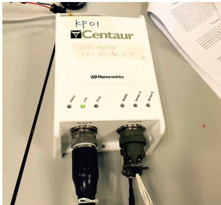
그림 19. 현재 장보고 기지에 설치되어 있는 지진기록계 모델. 왼쪽 커넥터는 지진계 센서(Trillium compact), 그리고 오른쪽 커넥터는 3개의 infrasonic 센서가 연결되어 있는 모습임.
