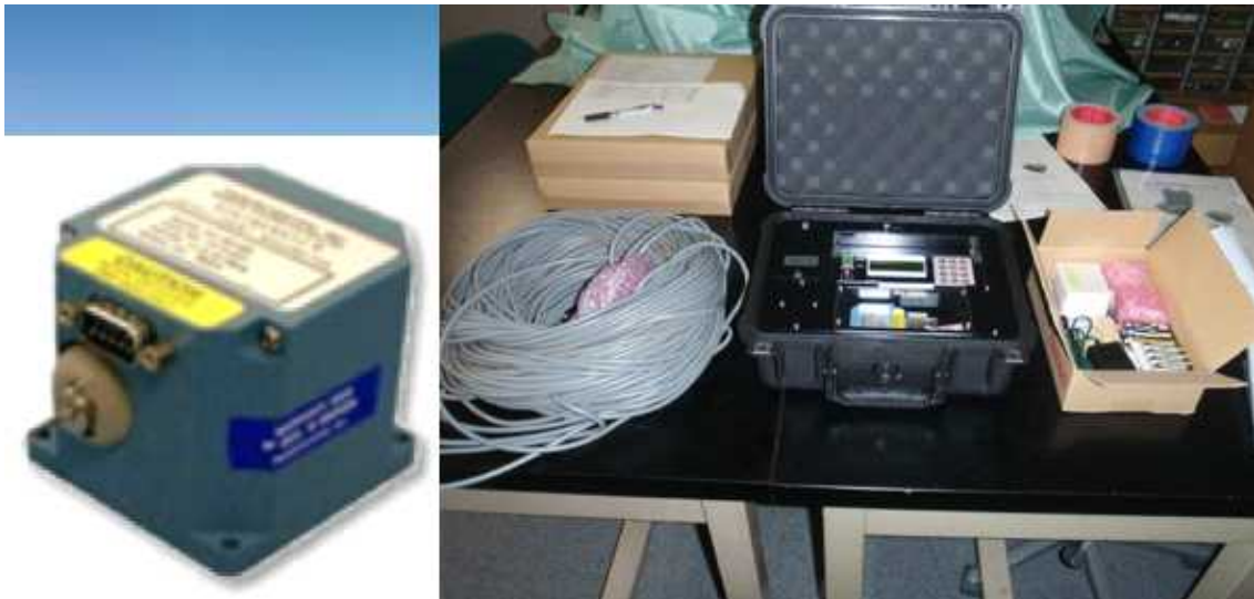
그림 29. 장보고 기지에 설치된 parometer sensor와 일체형으로 제작된 기록계
