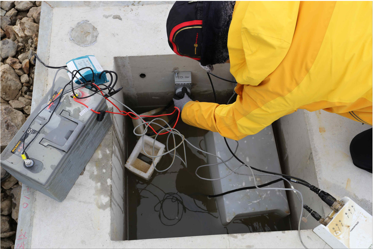
그림 42. 2013년-14년 하계 남극탐사 기간중에 설치한 장보고 기지 지진관측소의 모습. 2014년 남극 하계 시즌 동안 장보고 기지 주변의 눈이 녹으면서 형성된 배수로에서 지진관측소로 유입된 물에 의하여 지진관측장비가 침수됨
