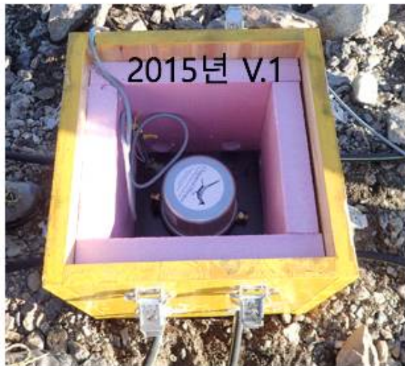
그림 24. 2015-16 남극 하계조사 기간중에 설치된 초기 인프라 사운드 보호 상자(v.1)와 입력 신호 강도를 높이기 위한 벨브 직접입력 방식으로 개량된 펠리칸 박스 형태의 보호 상자(v2)
