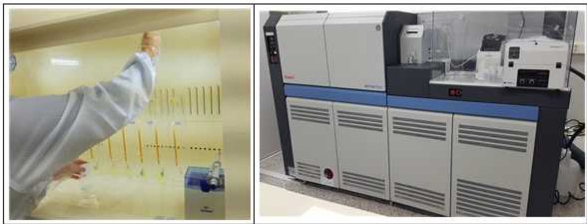
그림 5.1. 극지연구소 청정 실험실 내 Hf 원소 분리 실험. 극지연구소 다중검출기 유도결합 플라즈마 질량분석기(NEPTUNE PLUS, Thermo Scientific)
