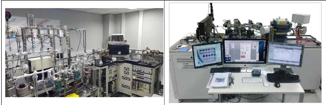
그림 5.7. 화산암 전암-광물 연대 분석: (좌) 불활성기체(He-Ne-Ar) 동위원소 질량분석 시스템(극지연구소), (우) 다검출기 불활성기체질량분석기( ^{40}\text{Ar} - ^{39}\text{Ar} ) 연대분석(한국기초과학지원연구원)
