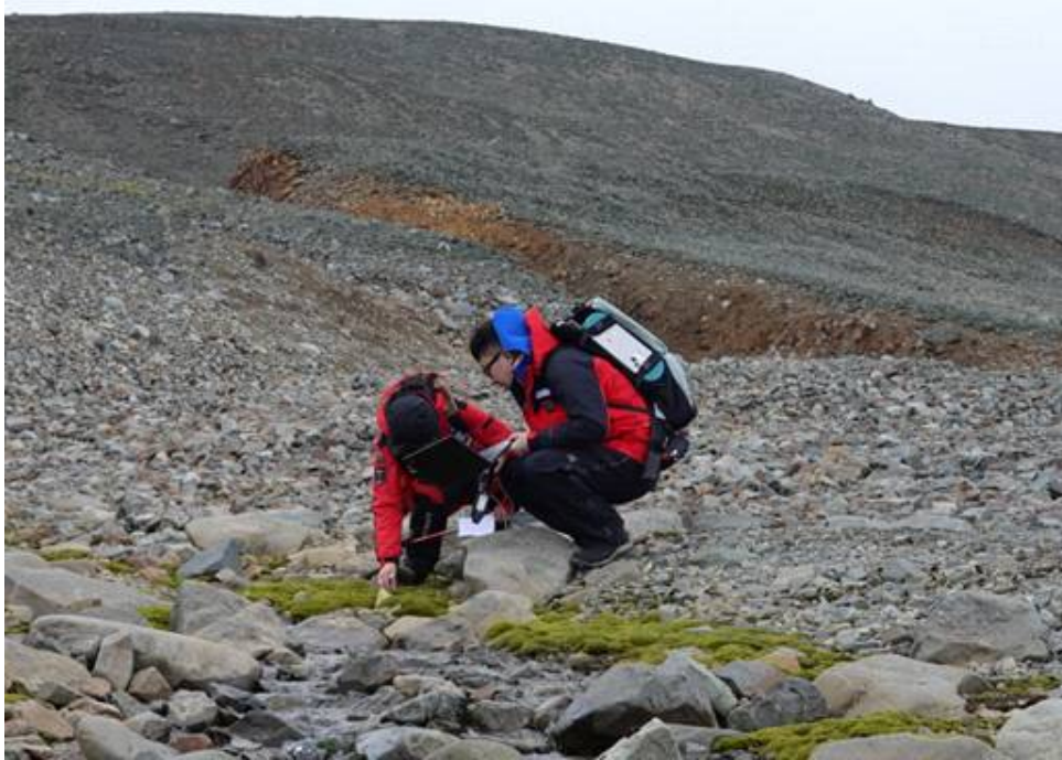
Figure 2. 휴대용분광반사측정기를 이용한 분광정보 측정 현장 사진
