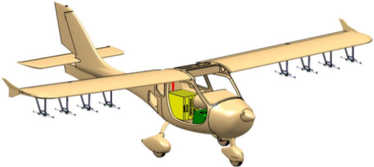
그림 3.22. VHF 안테나, 파일론, 레이더 시스템 및 자율비행제어 시스템을 갖춘 Flight Design사 CTLS
