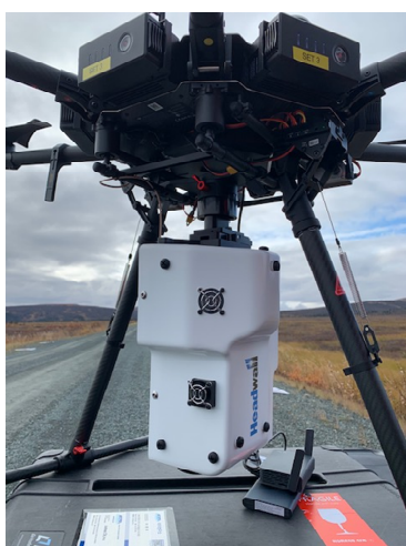
그림 3.27. 초분광 VNIR-SWIR 센서가 드론에 장착되어 운용 시험
