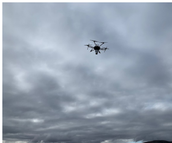
그림 3.27. 초분광 VNIR-SWIR 센서가 드론에 장착되어 운용 시험
