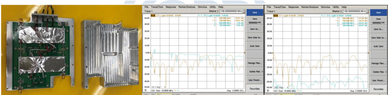
그림 3.15. (왼쪽)프로토타입 T/R 모듈과 커버 플레이트. (중간)송신기와 안테나 간 삽입손실 측정값 (오른쪽)송신기와 안테나 간 isolation 측정값
