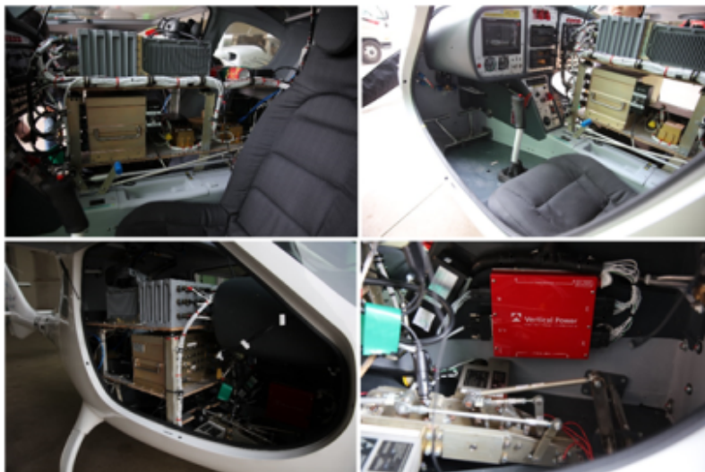
그림 3.2. 한서대학교 OPV시스템 비행체 내부 개조 형상
