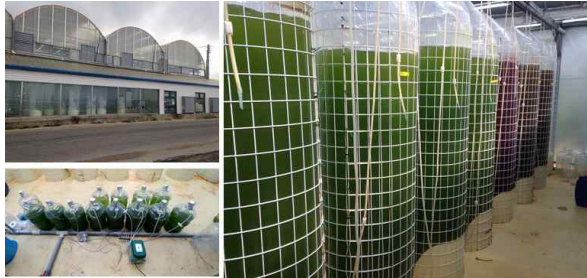
그림 23. 비엠바이오 전경(오른쪽 위), 대량배양 전 seed culturing (오른쪽 아래), 각 400L 배양 tube 내에서 배양중인 미세조류 균주들
