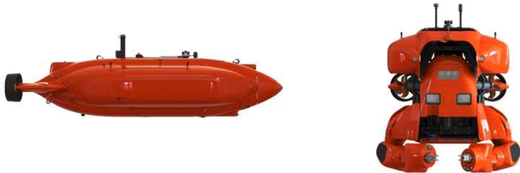
그림 10 AUV mode(좌)와 ROV mode(우)
