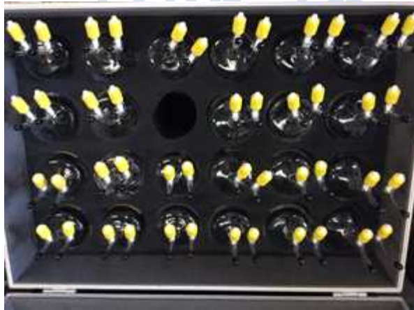
그림 11. 현장에서 실코켄 캐니스터를 보조하는 편 공기 채취 컨테이너인 유리 플라스크
