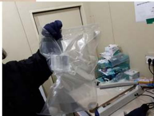
그림 5. 현생 대기와의 노출을 막기 위해 일반 포장 방식에서 비닐 내부의 현생 공기를 진공 펌프로 제거한 후 고온의 열처리로 입구를 밀봉하는 Sealer와 진공포장용 내열성 특수 비닐을 사용하여 진공포장 테스트를 진행하였고, 성공적으로 사전 검증을 통과하여 현장에서 사용할 수 있을 것으로 기대된다.
