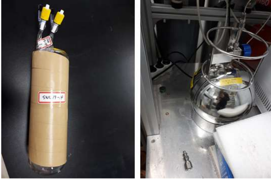
그림 8. 현장에서 사용할 유리 플라스크와 실코캔 캐니스터
