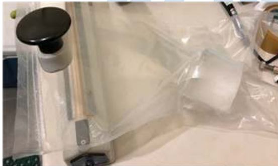
그림 4. 기존에 사용하던 스테이플러를 이용한 일반 포장 방식. 샘플링한 빙하 샘플이 남극 현장에서부터 실험실 냉동고까지 꾸준하게 현생 대기에 노출되어 post coring 효과가 나타나는 원인이 된 것으로 추정된다.
