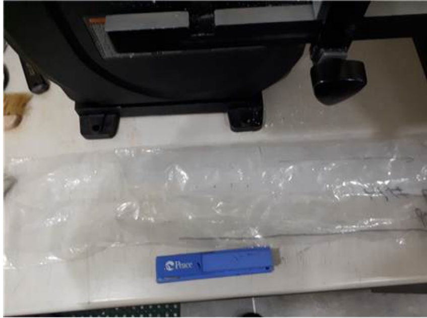
그림 4. 기존에 사용하던 스테이플러를 이용한 일반 포장 방식. 샘플링한 빙하 샘플이 남극 현장에서부터 실험실 냉동고까지 꾸준하게 현생 대기에 노출되어 post coring 효과가 나타나는 원인이 된 것으로 추정된다.
