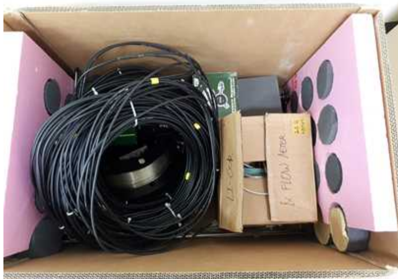
그림 12. 데카본 튜브와 Flow meter 등 편 공기 추출에 사용되는 장비들
