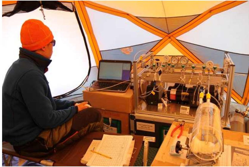
그림 2. 남극 Styx 편층의 공기를 채집하는 모습. 펌프시스템을 이용하여 3리터 유리플라스크에 편공기를 채집하는 모습.
