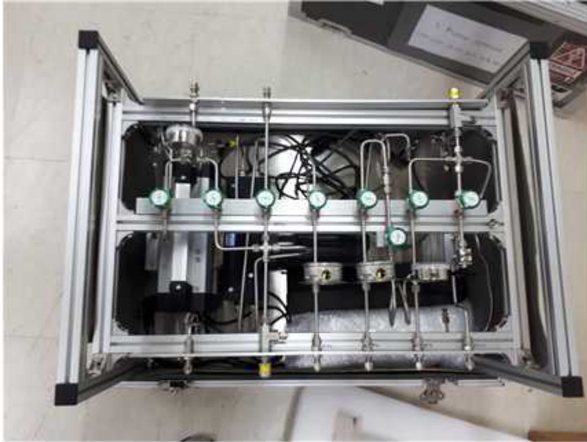
그림 9. 펌프로 구성된 편 공기 채집을 하는 펌프 시스템.
