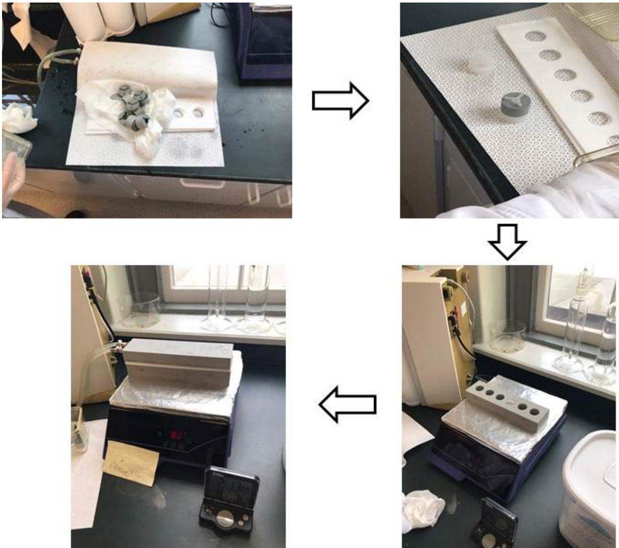
그림 5. Microdistillation 과정.
