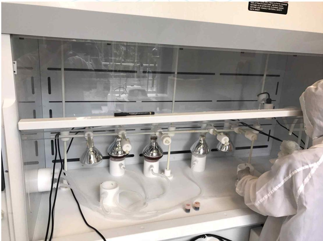
그림 4. 다트머스 대학교에 설치된 Os용 evaporation tool.
