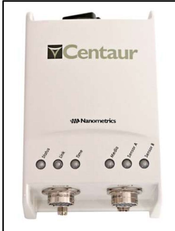
그림 79 Nanometrics Centaur 24 bit Digitizer.
