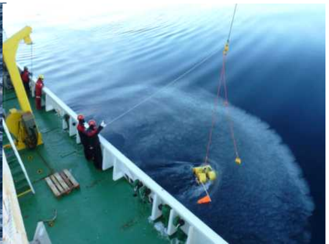
그림 293 해저면 지진계 설치 및 회수
