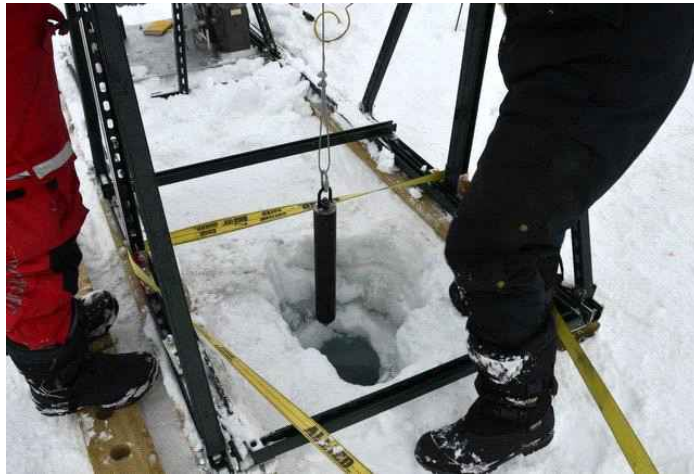
그림 150 접지 와이어 및 무게추 설치
