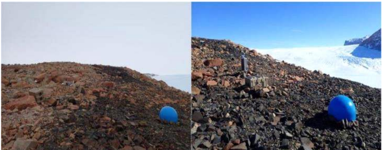
그림 130 강풍에 파손된 KN02 관측소 전경(좌), 솔라패널 Tower를 반으로 줄여 복구한 모습(우)
