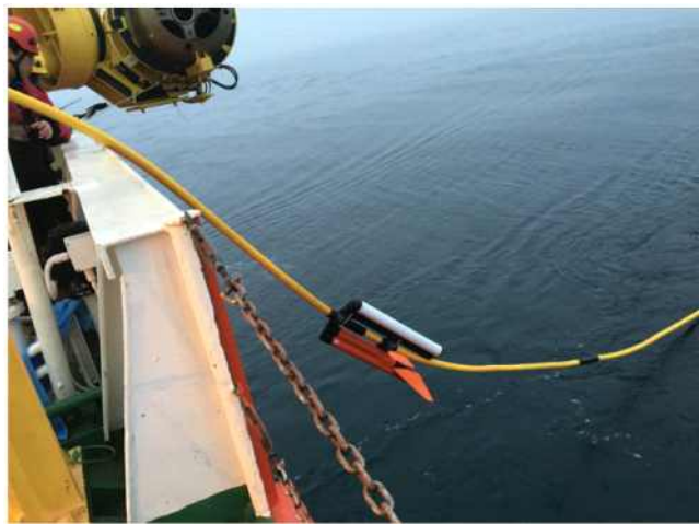
그림 300 다중채널 탄성과 탐사자료 획득을 위한 에어건 및 스트리머 (Streamer) 설치 및 탐사 과정 (상) 다중채널 탄성과 탐사자료 획득을 위한 에어건 장착 및 설치 (하) 스트리머 설치, 탐사 진행 중의 사진
