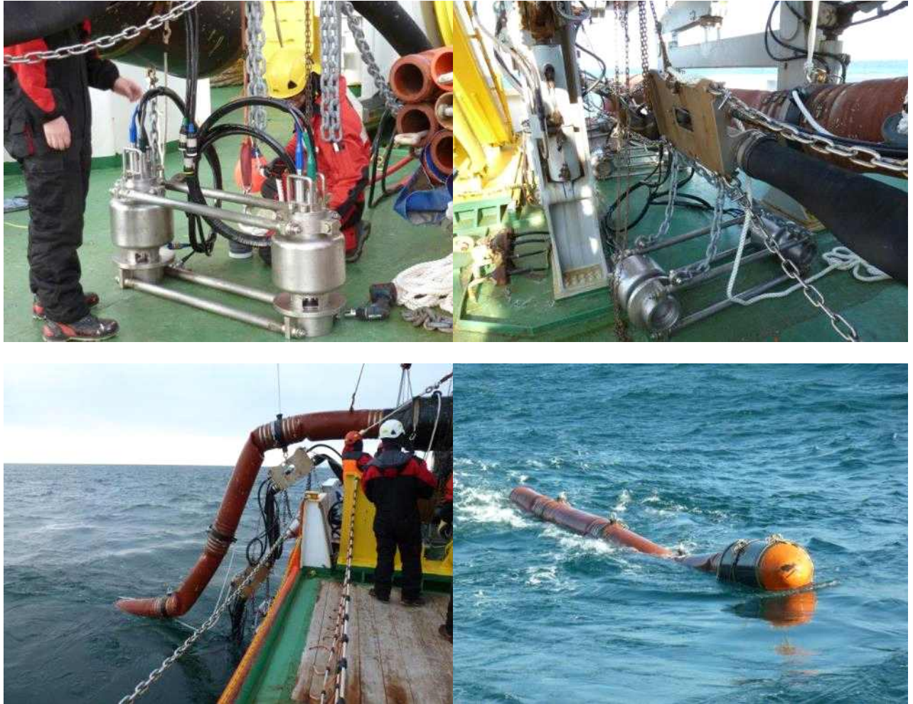
그림 294 Wide Angle Seismic 자료 획득을 위한 대용량 에어건 조립 및 설치
