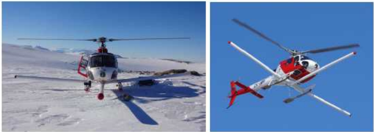
그림 426 헬리콥터 항공 지구물리 탐사 시스템 (미국 UTIG와 공동 탐사 수행); 빙하투과 레이더, 레이저 고도계, DSLR 카메라 탑재
