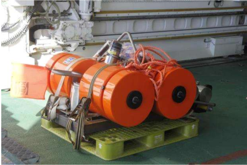
그림 196 KUM사의 해저면 지진계, LOBSTER의 모습. 티타늄 프레임에 앵커, 부이, 센서, 기록계, 배터리, 어쿠스틱 릴리저, 압력 센서가 일체형으로 조립됨
