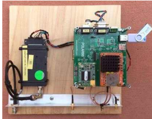
그림 636 개발된 무선통신 시스템을 이용하여 개발중인 GPS RTK 시스템
