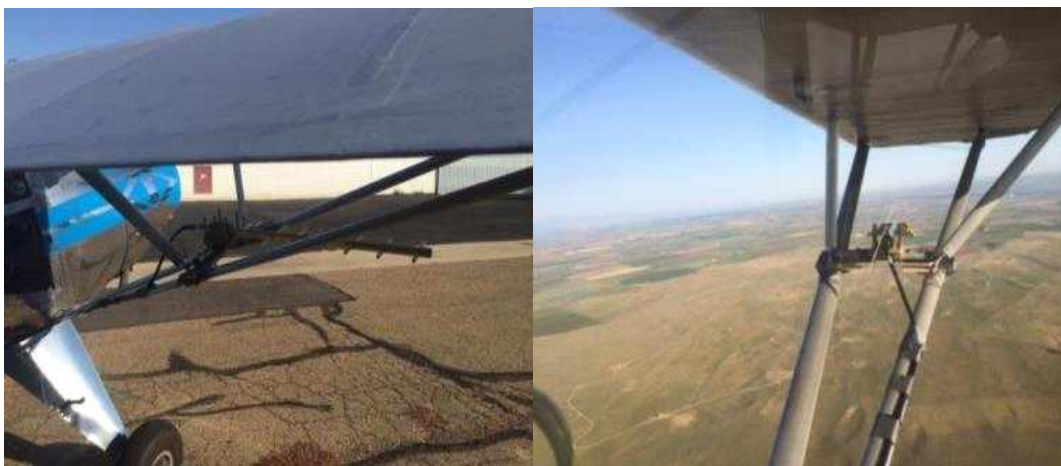
그림 635 무선 전송 시험: 경비행기 운행 중 무선 전송 시험 수행
