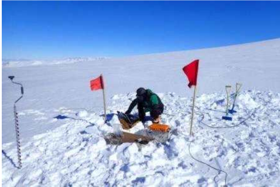
그림 182 멜번 화산에 설치된 MT 관측 장비
