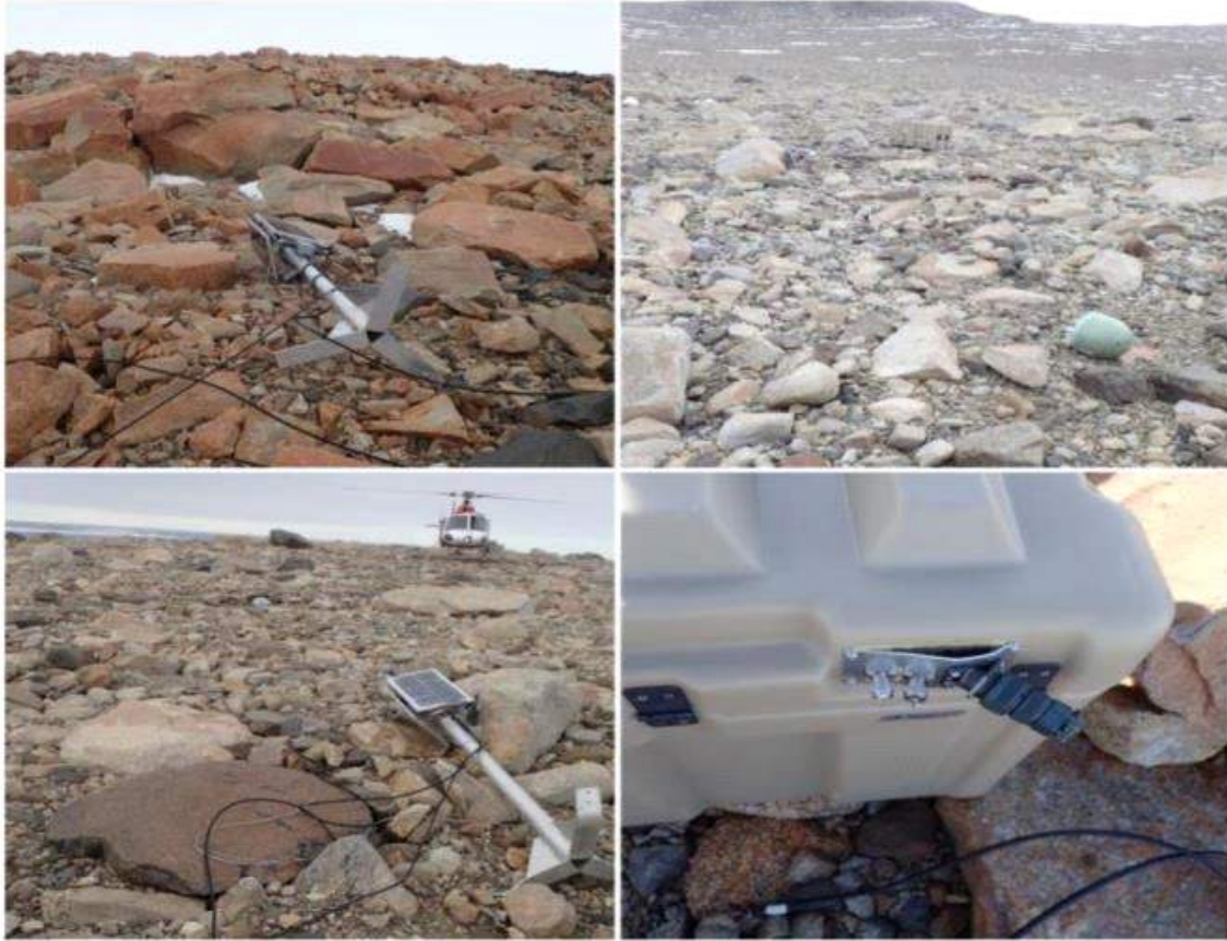
그림 131 동계시즌 강풍에 파손된 난센빙봉 지진 관측소들의 모습 (좌측 상단부터 시계방향으로 KN02, KN01, KN02, KN01)
