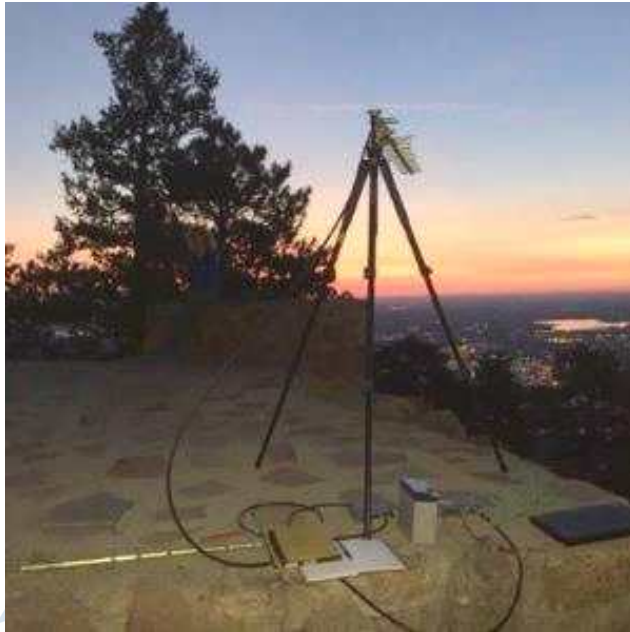
그림 634 무선 전송 시험: 지상 무선 중계기
