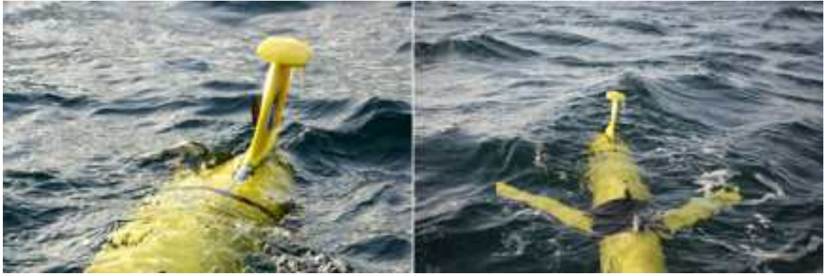
그림 273 글라이더 회수 당시 통신 모듈에 얼음이 맺힌 모습
