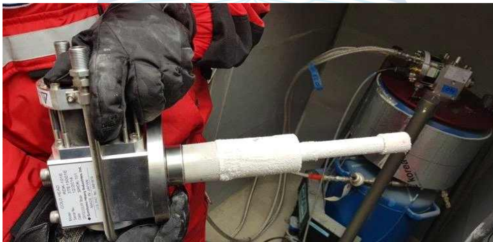
그림 192 초전도 중력계 cold head 교체
