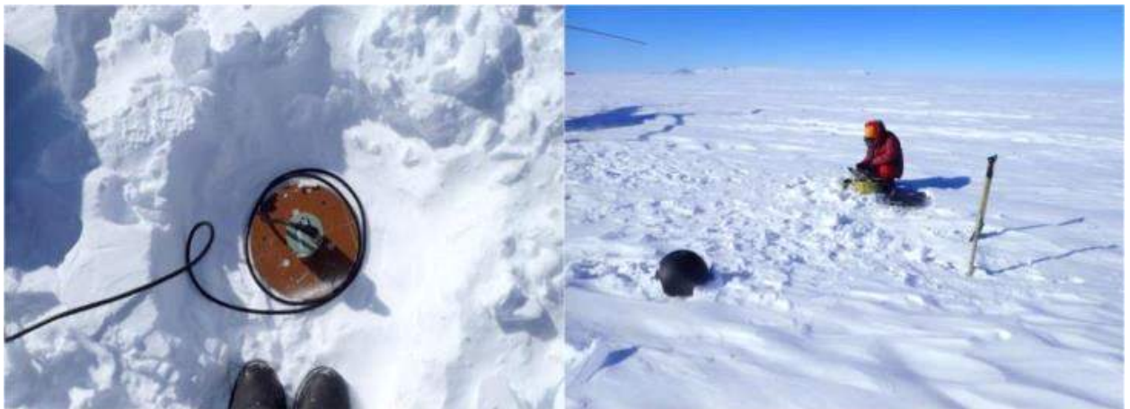
그림 136 대륙 빙하 위의 눈이 많은 지형에 설치한 임시 지진관측소 설치 과정
