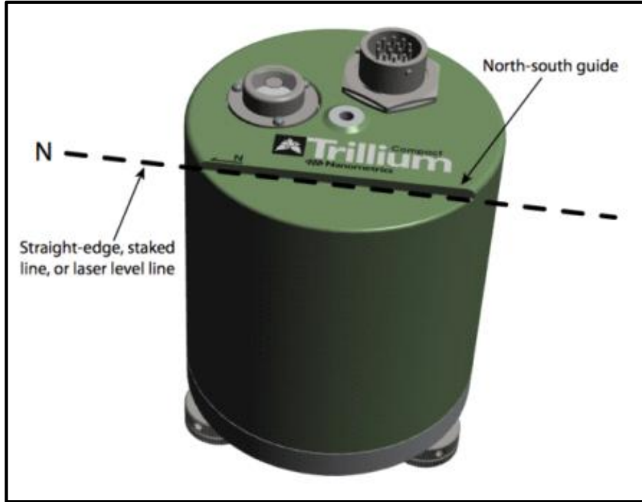
그림 75 휴대성이 뛰어나고 고주파 빙진 및 120초 주기의 신호까지 안정적으로 관측할 수 있는 Nanometrics 사의 Trillium Compact 광대역 지진관측 센서.
