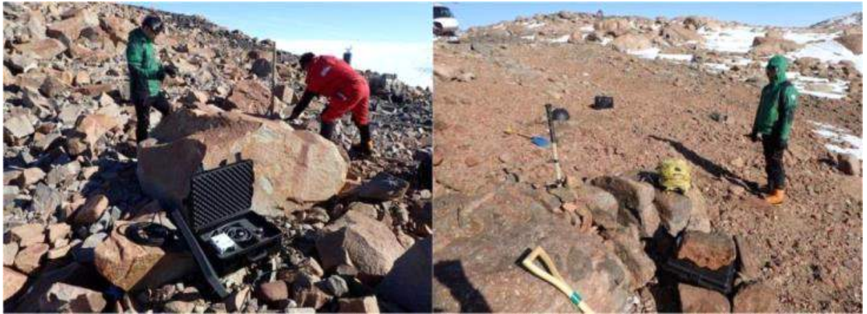
그림 135 암반지대에 설치한 임시 지진관측소 설치 과정
