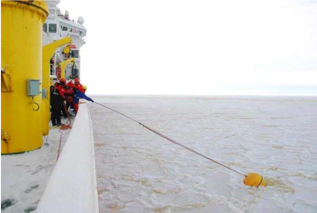
그림 314 회수 시 조류에 의해 밀려든 해빙에 플로트가 끼인 상황
