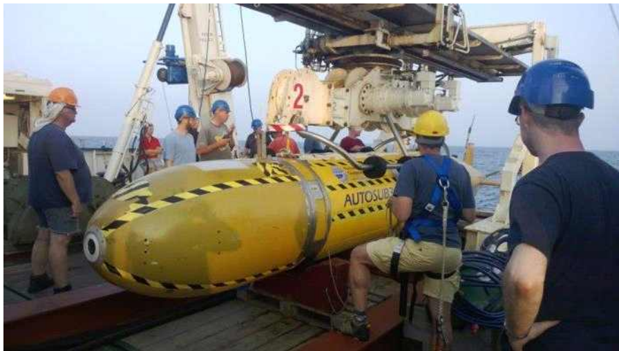
그림 55 영국 BAS와 NOC에서 개발한 빙봉 하부 탐사용 무인 잠수정 Autosub3
