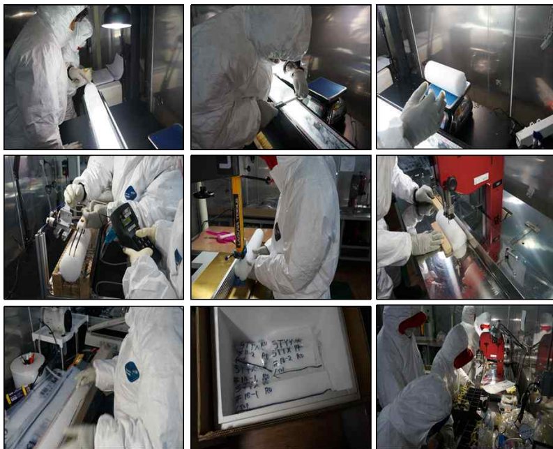
그림 3.1.25 스틱스 빙하코어 절삭과정 및 기초조사
