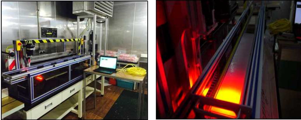
그림 3.1.27 빙하코어의 표면영상 촬영장비 및 촬영과정
