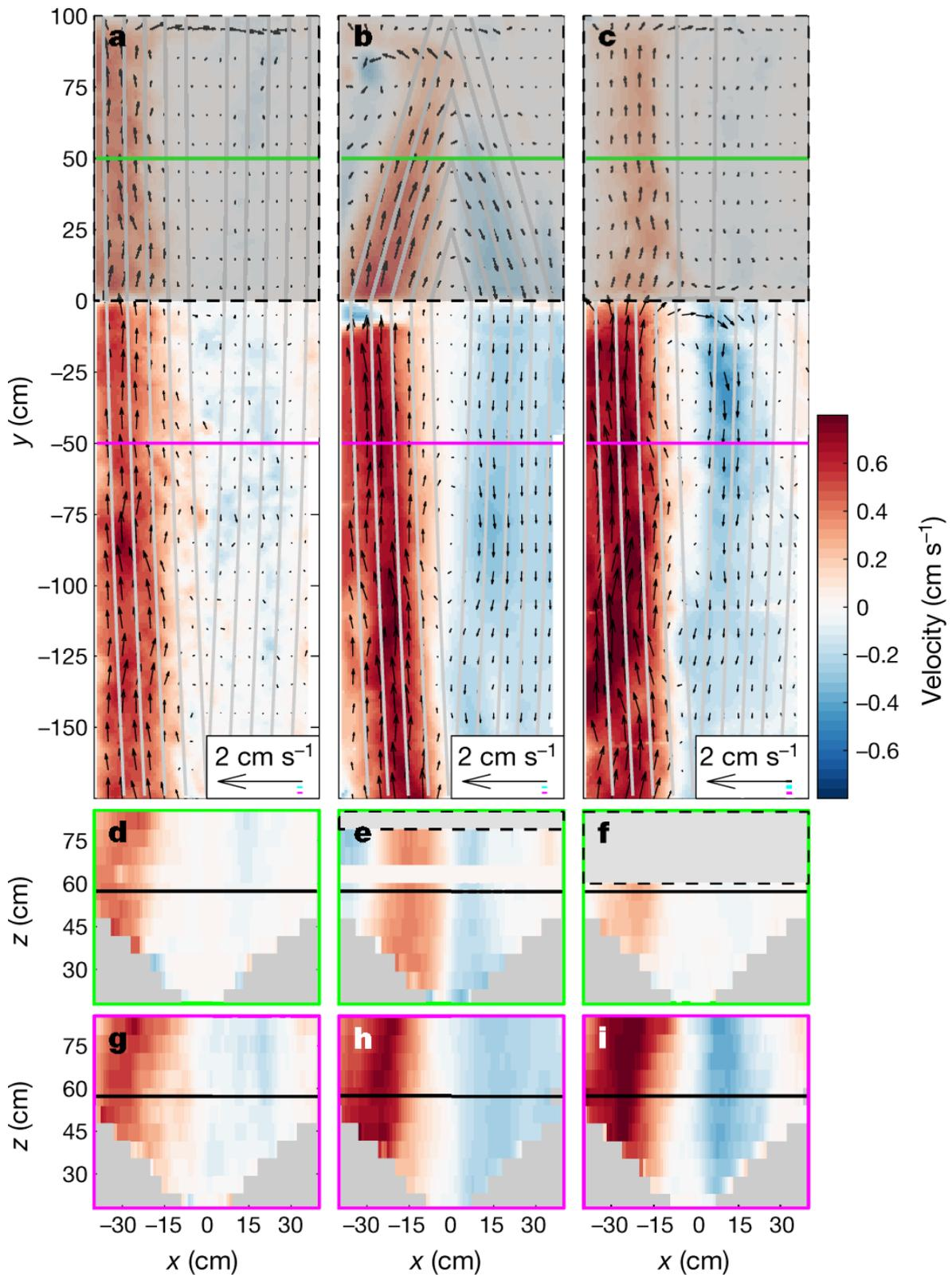
빙봉의 절반 이상이 균일하게 바다에 잠겨있을 때 (c, 위 수조실험 모식도 d) 빙봉 하부 (검정색 점선 불투명 박스)의 유속은 빙봉 전면에 비해 약 70% 감소하였으며, 빙봉이 전혀 잠기지 않거나 (a), 사선으로 잠겼을 때 (b) 보다 감소폭이 큰 것으로 확인되었다.
