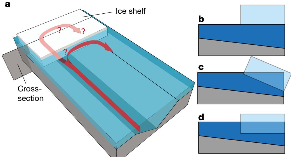
수심에 따른 유속 변화 분석을 위한 빙붕 유형 별 수조실험 모식도 (a). 빙붕이 바다에 전혀 잠기지 않았을 때 (b), 빙붕이 사선의 형태로 바다에 잠겼을 때 (c), 빙붕의 절반 이상이 바다에 균일하게 잠겼을 때 (d, 실제 빙붕 모습과 유사)
