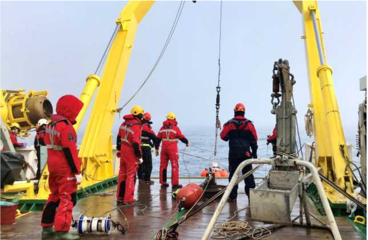
북극해 수중에 장기계류관측시스템을 설치하는 모습
