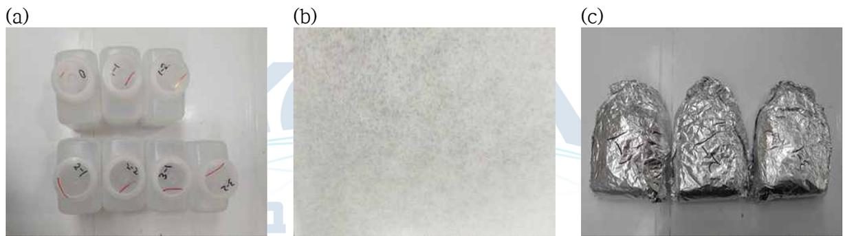
**Figure 2** 풍화 모사 실험 진행 사진. (a) 부피 500 ml HDPE 사각병에 암석 분쇄물과 pH 3의 반응용액을 넣는다. (b) 암석 분쇄물을 용기 바닥에 균질하게 펼친다. (c) 반응용기를 밀봉하고, 빛을 차단하기 위하여 은박지로 감싼 후 물-암석/광물 세트는 상온에, 얼음-암석/광물 세트는 영하 20도의 저온반응기에 보관한다.
