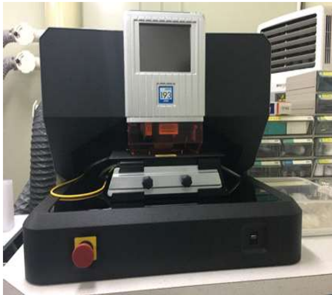
그림 17. 멜트 포유물 미량원소 분석에 이용하였던 LA-ICP-MS 기기 사진.
