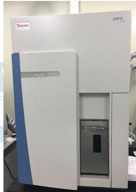
그림 17. 멜트 포유물 미량원소 분석에 이용하였던 LA-ICP-MS 기기 사진.
