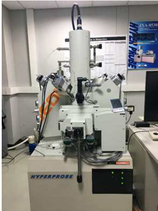
그림 7. 극지연구소가 보유한 FE-EPMA(JEOL JXA-8530F). 위 기기를 이용하여 화성암 글라스의 주원소 및 일부 휘발성 원소를 분석하였다.
