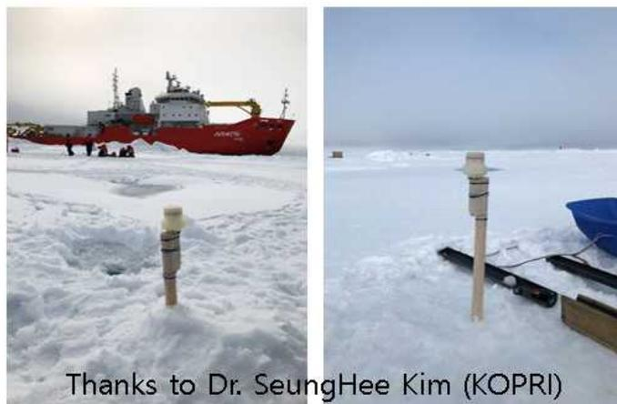
그림 18 해빙에 설치한 GPS 신호기의 모습
