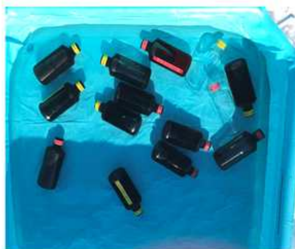
그림 7. 식물플랑크톤의 탄소 및 질소 흡수율 현장배양 사진.
