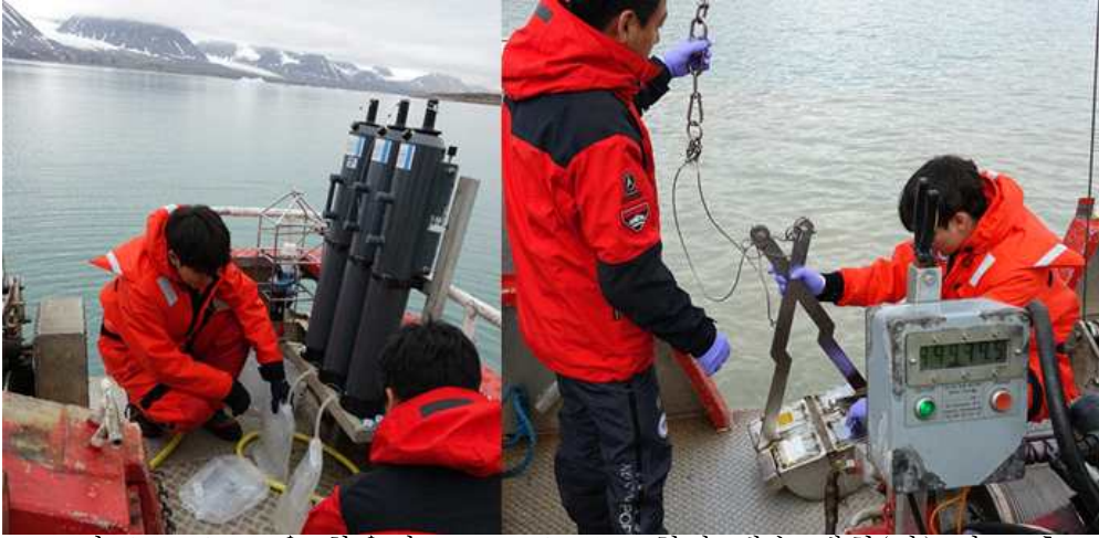
그림 6. Teisten을 활용한 Kongsfjorden 현장 해수 채취(좌) 및 표층 퇴적물 채집(우) 모습
