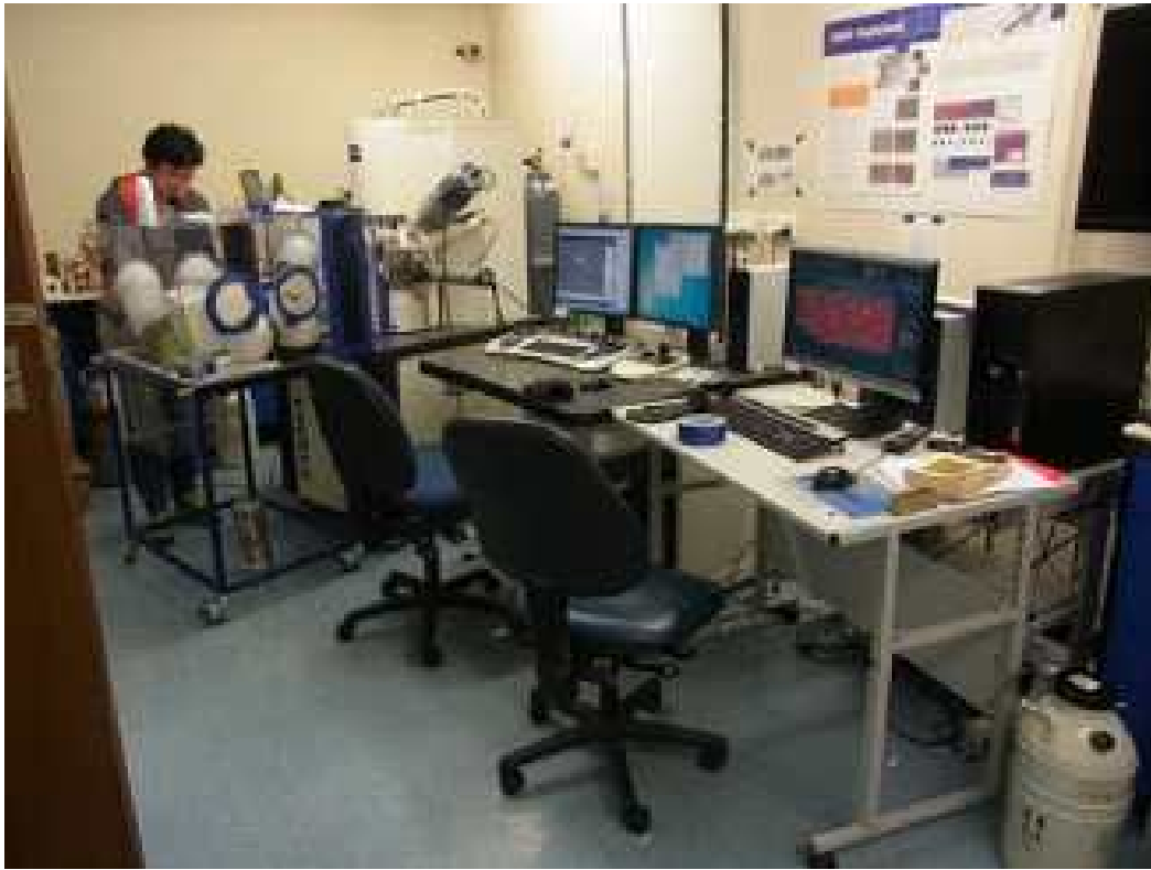
그림 7. 뉴질랜드 오타고대학에 설치된 얼음의 결정방향성을 측정할 수 있는 cryo-SEM-EBSD 장비
