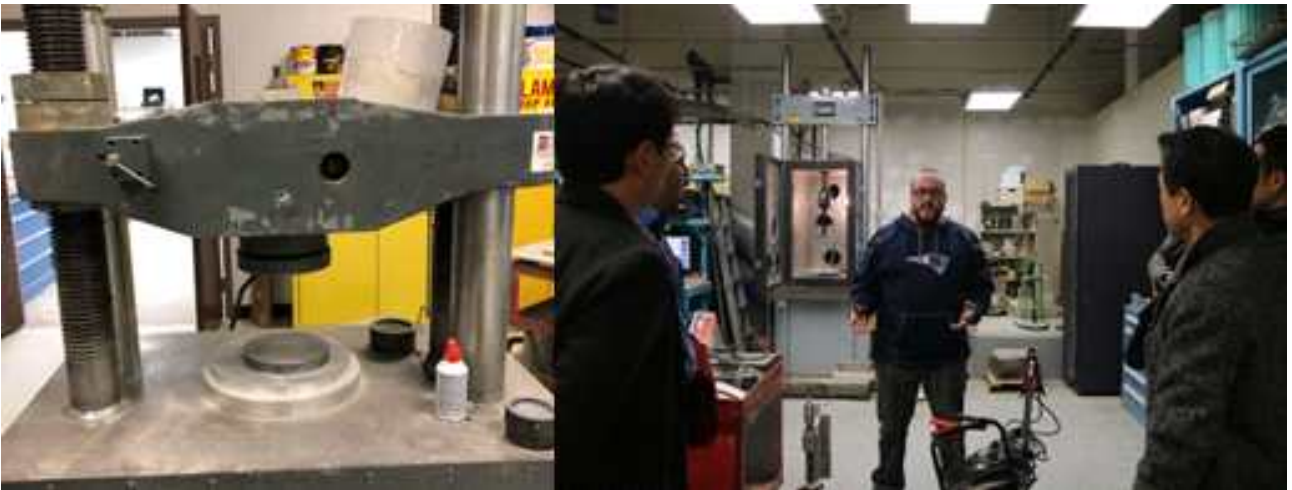
그림 10. 재료 실험실. (좌) 압축강도 실험 장치, (우) 매질의 저항 강도 측정
