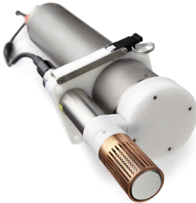
그림 4. 아라온호의 현장관측에 사용된 pCO2 센서
