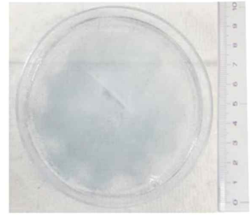
그림 7. (a) 얼음 표면에서의 PEDOT:PSS 전도성 고분자 막 합성 과정의 도식 (b) 약 10 cm 크기의 대면적으로 합성된 전도성 고분자 막의 사진.
