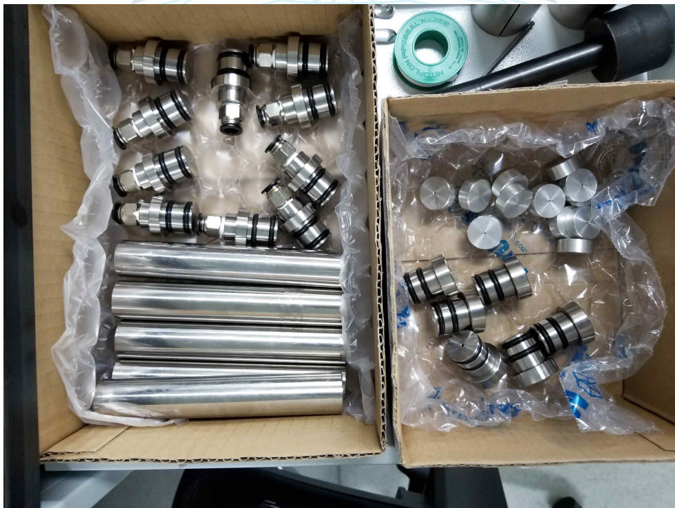
그림 2. 미국 펜실베이니아대학에 있는 합성얼음을 제작하는 원통형 틀과 마개
