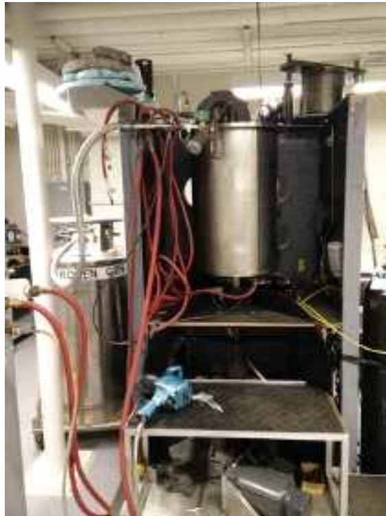
그림 5. 미국 펜실베니아대학에 설치된 고압저온 얼음 변형장비
