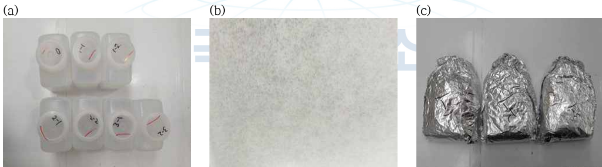
그림 2. 풍화 모사 실험 진행 사진. (a) 부피 500 ml HDPE 사각병에 암석 분쇄물과 pH 3의 반응용액을 넣는다. (b) 암석 분쇄물을 용기 바닥에 균질하게 펼친다. (c) 반응용기를 밀봉하고, 빛을 차단하기 위하여 은박지로 감싼 후 물-암석/광물 세트는 상온에, 얼음-암석/광물 세트는 영하 20도의 저온반응기에 보관한다.
