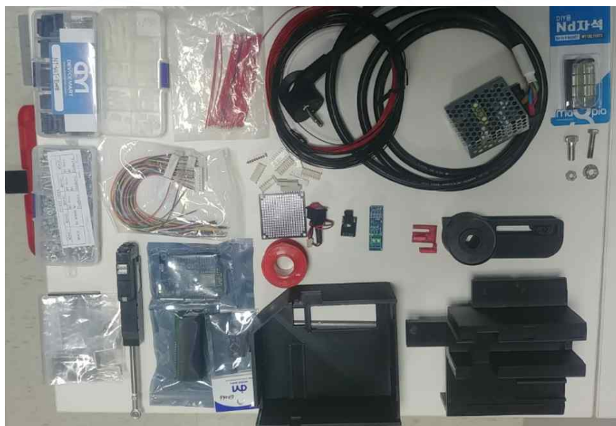
그림 30. 댐퍼 제어 액츄에이터 제작에 사용된 부품류
