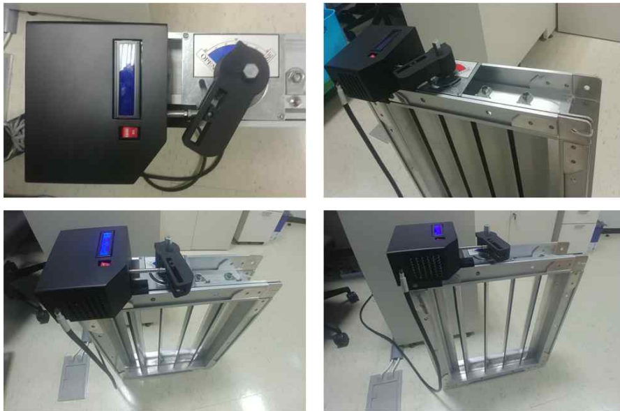
그림 34. 댐퍼 제어 액츄에이터를 기존 수동 댐퍼에 결합한 모습
