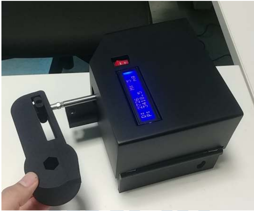
그림 33. 댐퍼 제어 액츄에이터 부품 조립 과정 2
