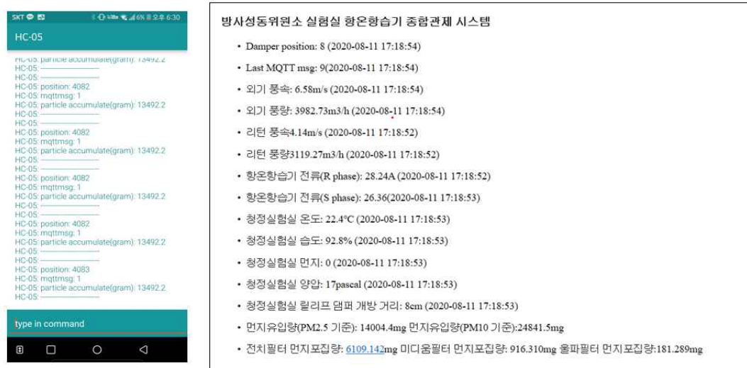
그림36. 블루투스를 이용한 제어 과정 모니터링(좌) 소켓통신을 이용한 방사성동위원소 실험실 지표 모니터링 화면(우)
