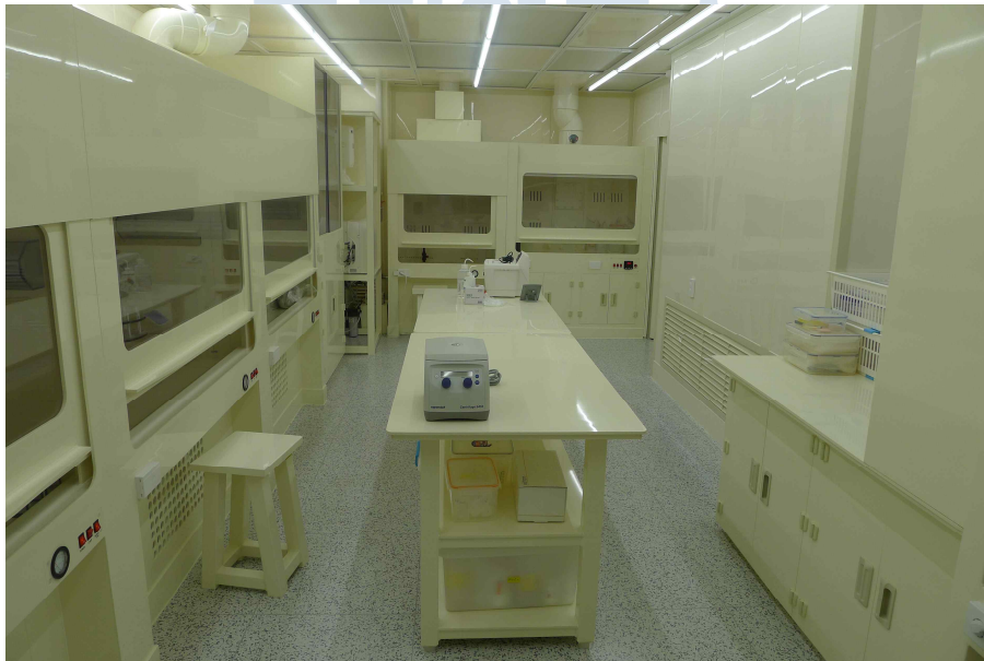
그림 1. 남극 지질 시료에서 방사성 동위원소를 분리하는 청정실험실
