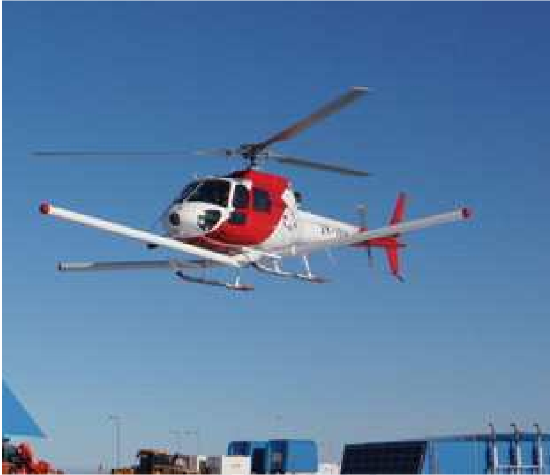
그림 19. 헬리콥터 탑재 빙하투과레이더 시스템
