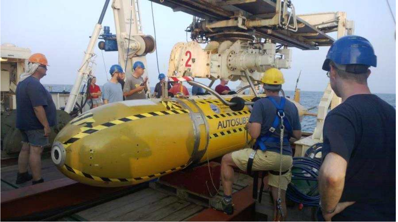
그림 7. 영국 BAS와 NOC에서 개발한 빙봉 하부 탐사용 무인 잠수정 Autosub3
