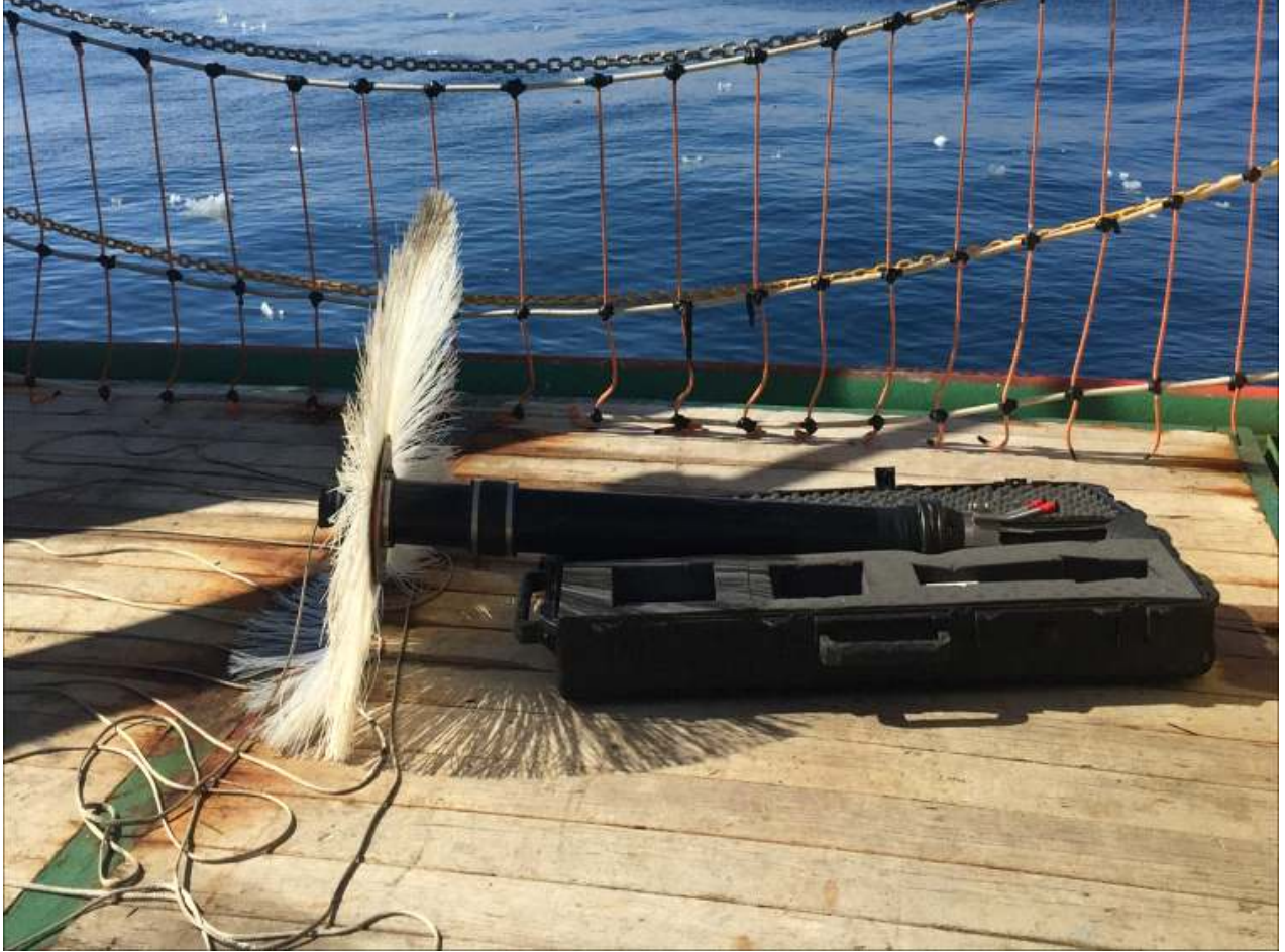
그림 23. 연구선에서 터블런스 관측에 쓰이는 Rockland VMP250IR 장비
