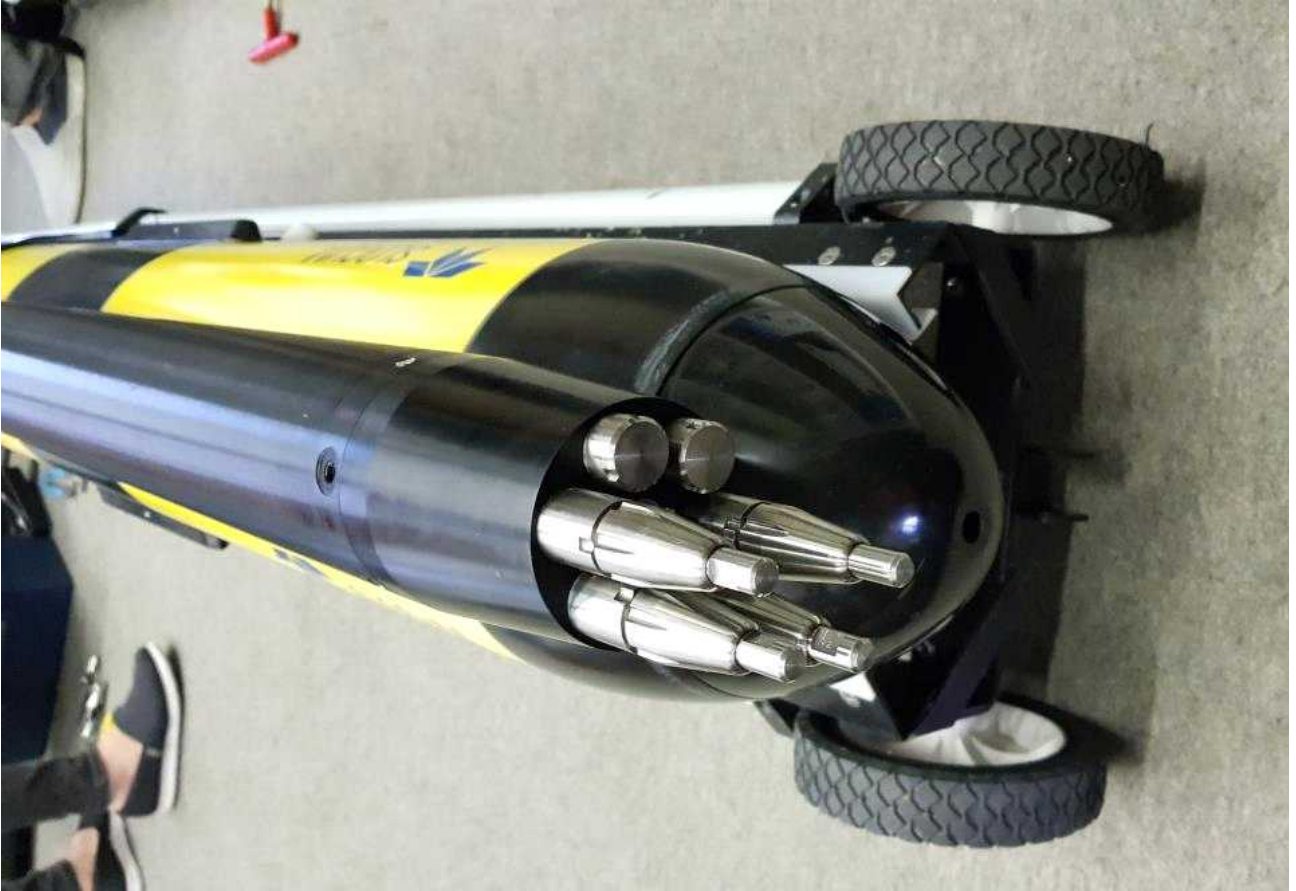
그림 22. 18/19 남극 하계 탐사에서 활용될 turbulence 측정장비가 장착된 Slocum 글라이더
