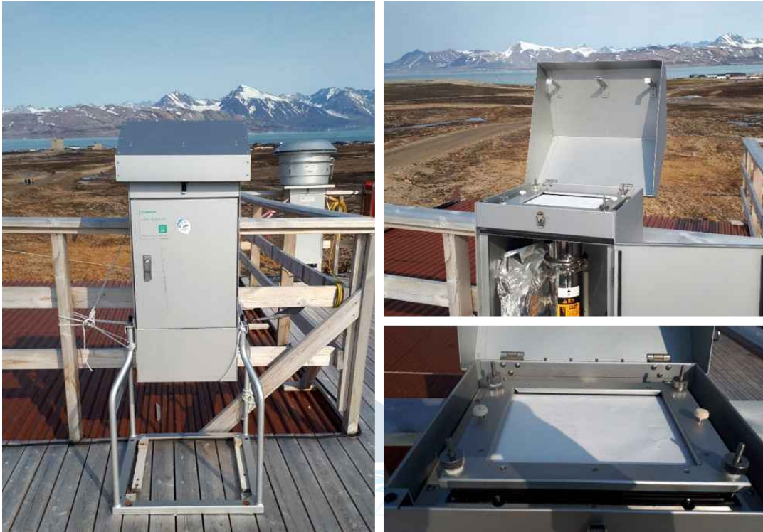
그림 52. High Volume Air Sampler를 이용한 대기 중 미세플라스틱 시료 채취
