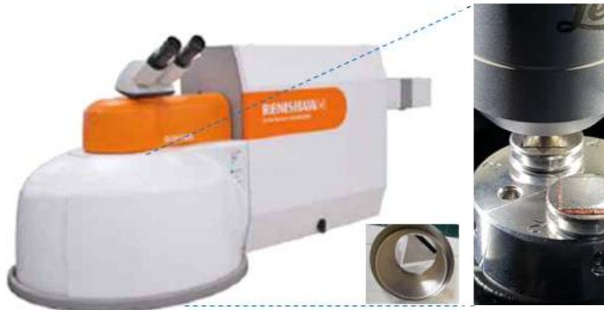
그림 47. Raman(Renishaw inVia Qontor)을 이용한 시료 측정
