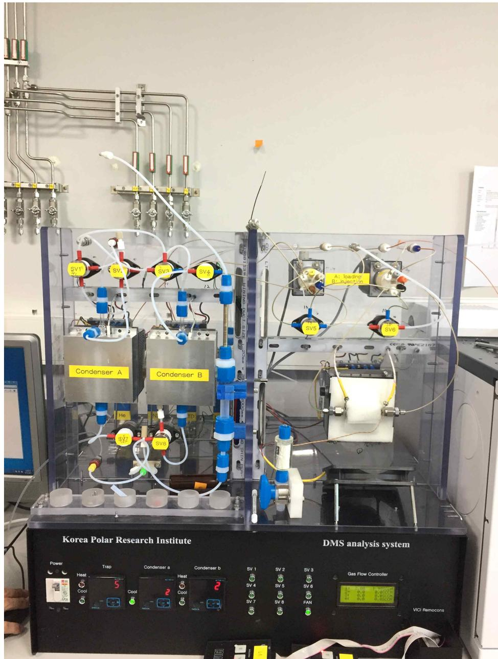
Fig. 3.3.33. 대기 DMS 농도 관측을 위한 자화 전처리 장치 (2017년 제작 완료)
