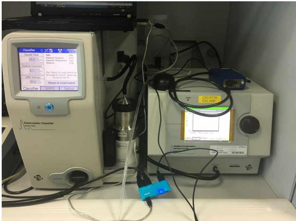
Fig. 3.3.1. 남극세종과학기지에 설치된 nano-SMPS 시스템
