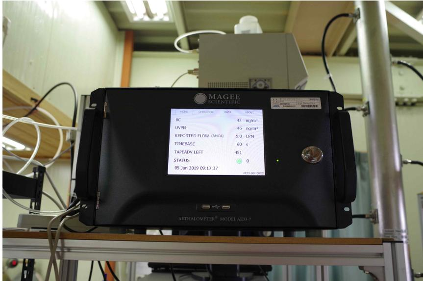
Fig. 3.3.6. 신규 aethalometer AE33.
