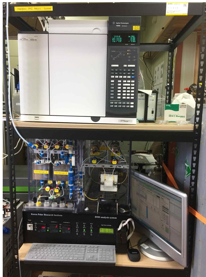
Fig. 3.3.36. 세종과학기지 대기빙하관측동에 설치한 대기 DMS 실시간 분석 장치
