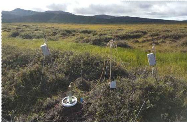
그림 24 지중침하계 설치 결과
