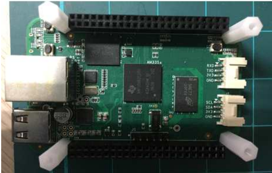
그림 1.34 게이트웨이용 PCB 설계 도면 및 시제품
