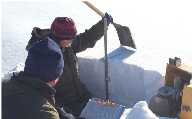
그림 10 눈의 밀도 및 온도 프로파일 측정
