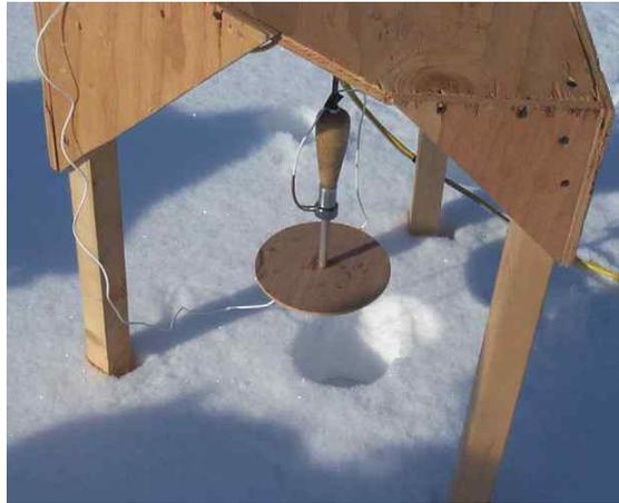
그림 8 Plate-sinkage apparatus
