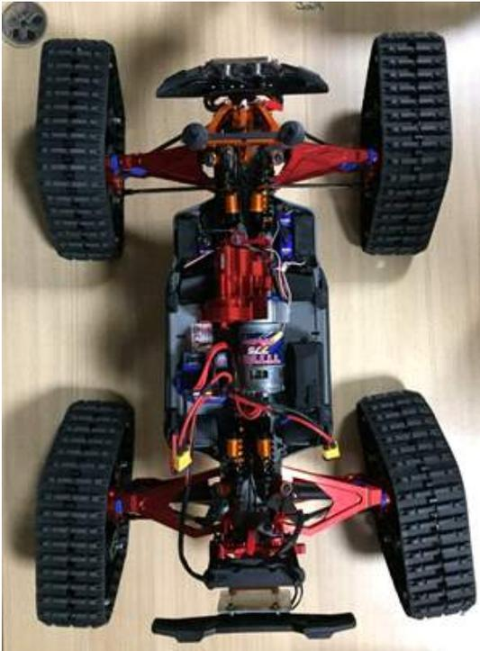
그림 2 영상, 조작 성능 테스트를 위한 소형로봇 플랫폼
