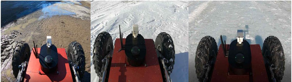
그림 21 주행 시험 지면(습지(좌), 빙설(중), 해빙(우))
