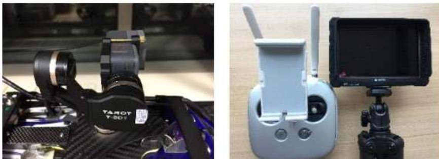
그림 25 모니터링용 영상 장비(4K 카메라+Gimbal Controller+Field Monitor)
