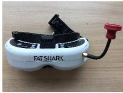
그림 26 Remote Controller용 영상 장비(FPV Camera+HDO Goggles)
