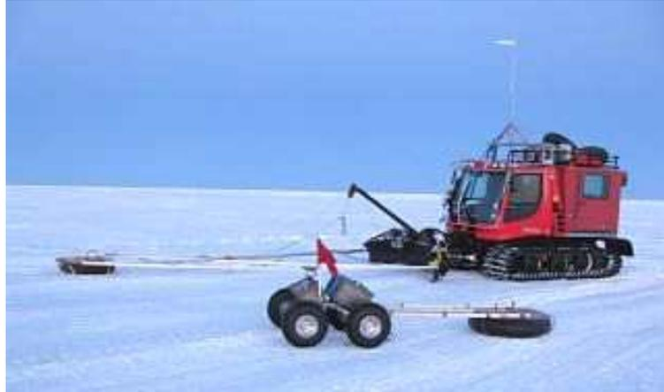
그림 14 Ground penetrating radar를 끌고 있는Yeti Rover
