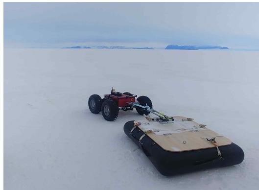
그림 22 견인 장치를 이용한 GPR 탐사
