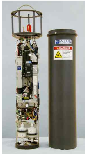
그림 4. (a) 광학영상장비 Imaging FlowCytobot (IFCB)와 (b) 아라온호 underway 해수 분석을 위한 설치과정
