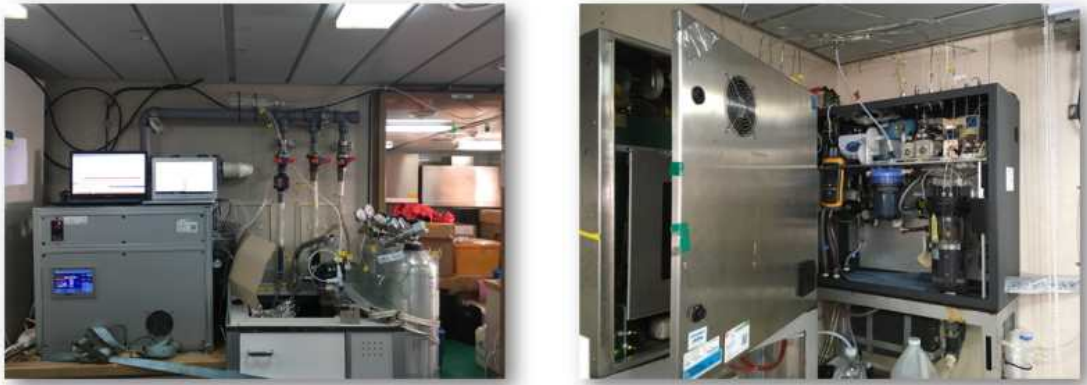
그림 1 아라온에 설치된 평형기주입식질량분석기 (EIMS) (좌)와 이산화탄소 분석시스템(우)
