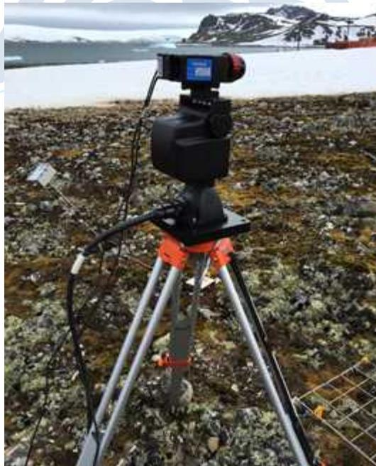
그림 4. Headwall Photonics 사의 Micro-Hyperspec Extended VNIR Imager
