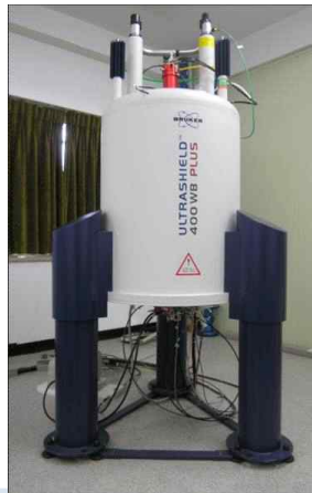
그림 17. 400MHz NMR 분광기
