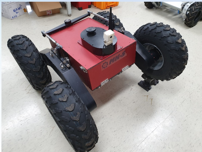
<장애물 극복시 4개 휠이 지면 접촉하고 본체는 양쪽 구동부의 평균 피치각 유지>
