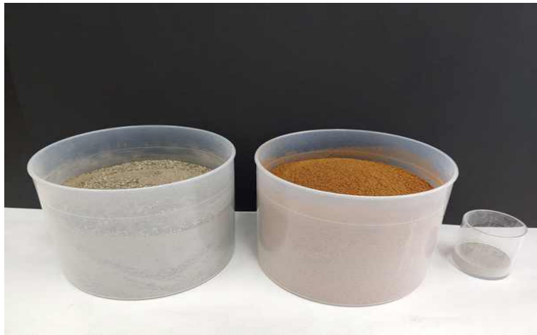
그림 16. 왼쪽부터 선처리 후, 마리넬리 용기에 담기 토양과 이끼 시료 그리고 오른쪽이 5 cm의 소형 비이커에 담긴 지의류.
