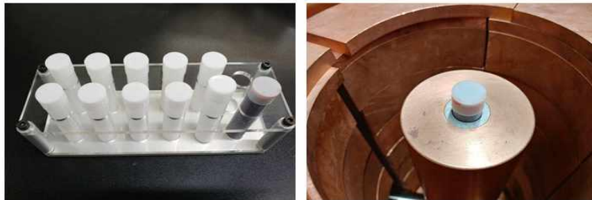
MCNP 모델링 최적화를 통해 제작된 샘플용기와 측정을 위해 Well 타입 HPGe 세팅된 샘플용기
