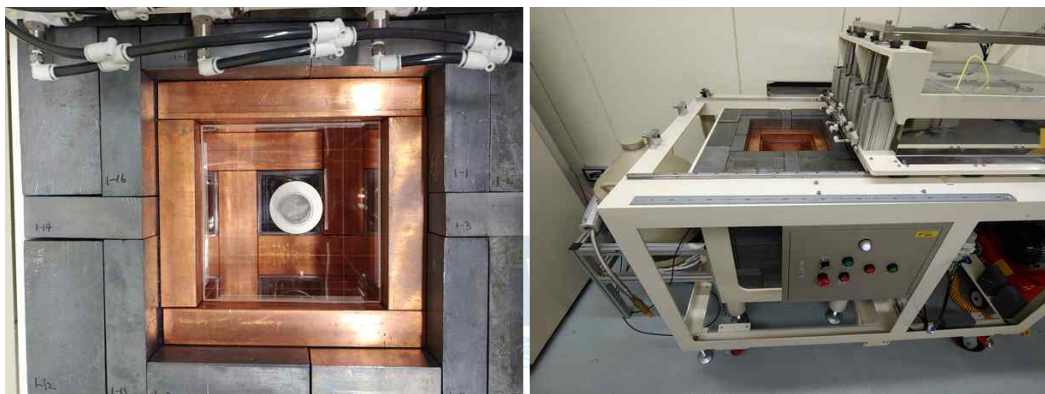
그림 17. 왼쪽은 내부 5 cm 두께의 구리와 외부 15 cm 두께의 납으로 둘러싸인 HPGe 검출기 헤드와 그 위에 놓여있는 지의류 시료. 오른쪽은 방사선차폐 검출시스템의 외부모습. 시료를 넣은 후 800 kg의 납문은 자동제어에 의해서 닫을 수 있다.
