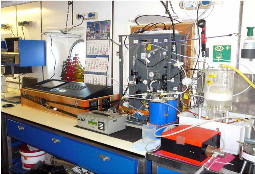
그림 2.1. 독일 GEOMAR에서 개발하여 활용 중인 기후변화물질 ( \text{CH}_4 , \text{N}_2\text{O} ) 분석기기
