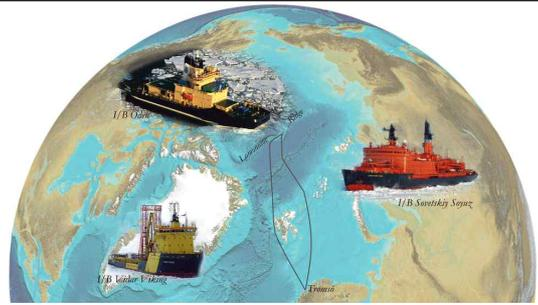
그림 8b. 2004년 유럽국제공동해저시추컨소시엄(ECORD)에서 최초로 북극점 인근 로모노소프해령에서 심부시추를 추진하였으며 이를 위해 러시아 핵추진쇄빙선 I/B Sovetskiy Soyuz 1척, 스웨덴 쇄빙선 I/B Oden 1척 및 시추선 I/B Viking이 선단을 구성하여 북극해 시추를 성공적으로 수행함
