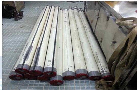
그림 4. 2015년 5월 동해 시험항해에서 최초로 아라온에 장착된 JPC 시추코어를 이용하여 약 30m의 롱코어 퇴적물을 성공적으로 시추함
