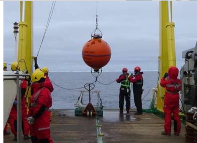
바다의 변화 관찰을 위한 수중 장기계류관측시스템 설치
