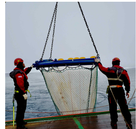
북극해에 서식하는 자치어를 채집하는 장비 운용하는 모습
