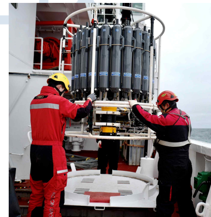
연구정점에서 해수의 수온, 염분 관측과 해수 샘플을 채취하는 CTD 장비 운용하는 모습
